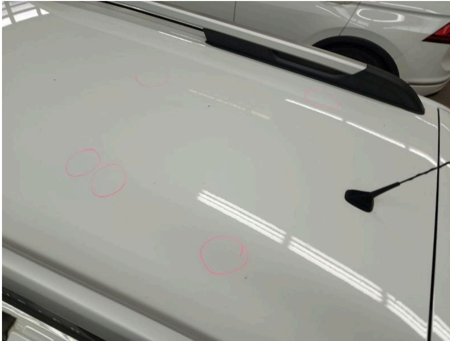
Bild 17 Dach Dachhaut 5 Dellen Dellen
