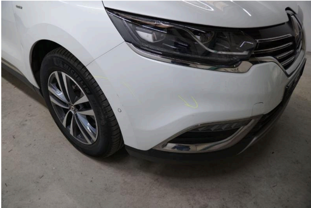
Bild 23 Fahrzeugfront Stoßfänger vorne verkratzt
