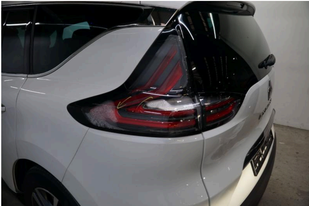
Bild 34 Fahrzeugheck Rückleuchte links undicht
