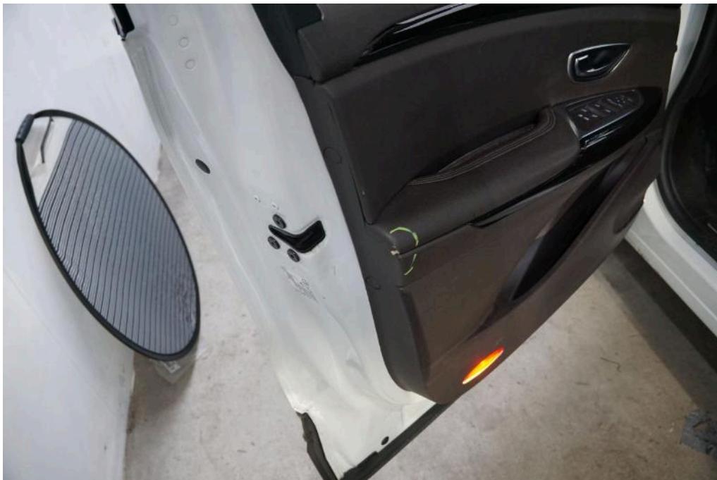
Bild 42 Innenraum Türverkleidung vorne links beschädigt
