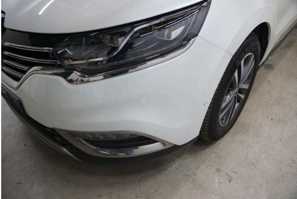
Bild 21 Fahrzeugfront Stoßfänger vorne verkratzt
