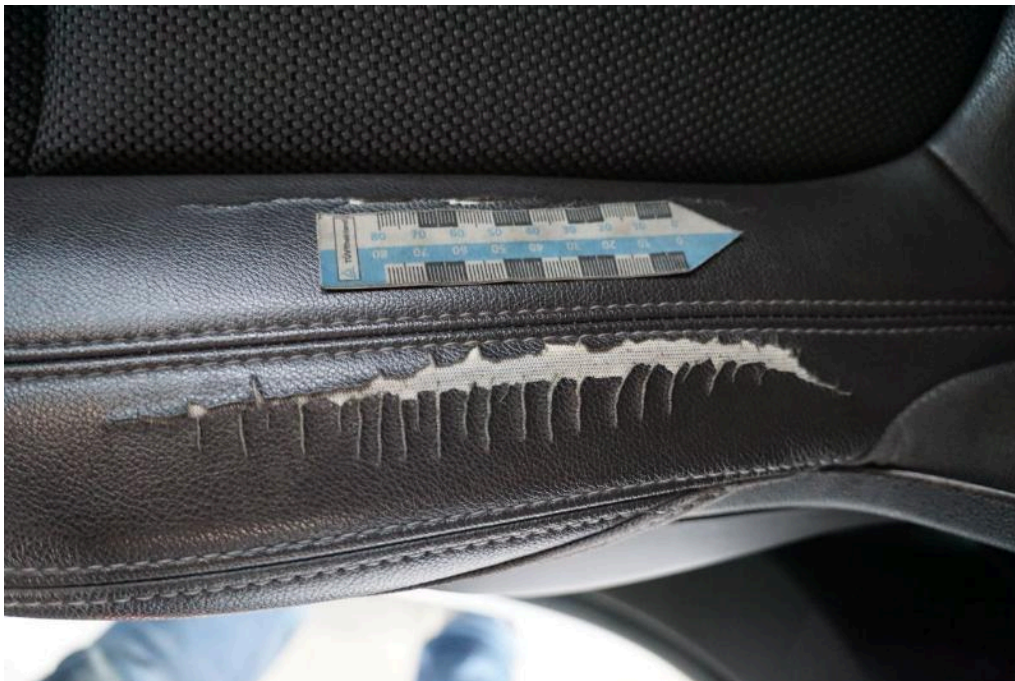
Bild 18 Innenraum Sitz vorn links gerissen / eingerissen
