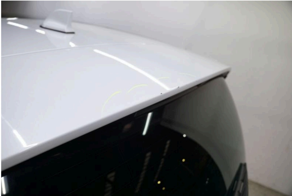
Bild 37 Dach Dachspoiler Kratzer
