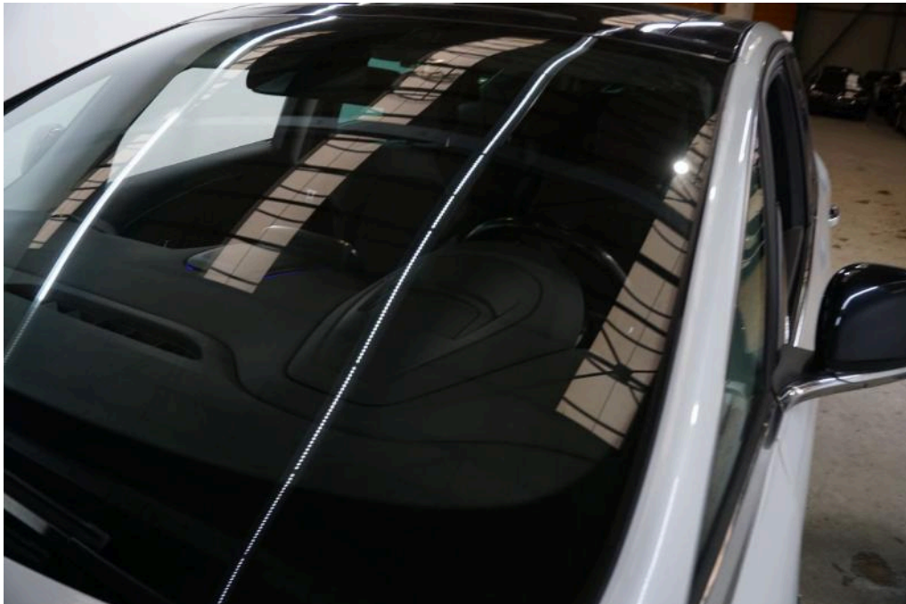
Bild 46 Fahrzeugfront Windschutzscheibe gerissen / eingerissen
