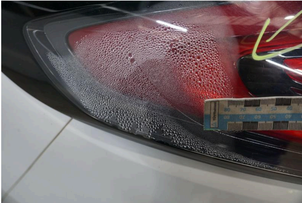
Bild 35 Fahrzeugheck Rückleuchte links undicht
