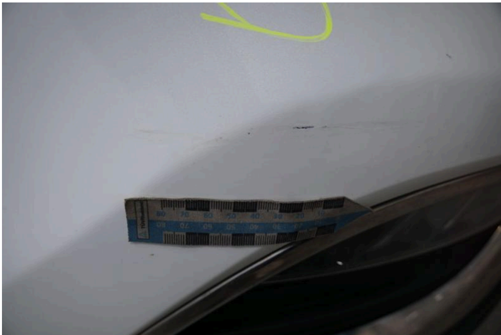
Bild 24 Fahrzeugfront Stoßfänger vorne verkratzt
