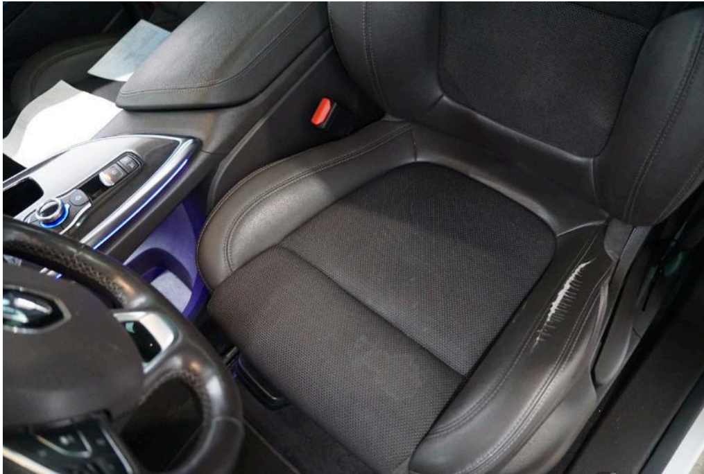
Bild 17 Innenraum Sitz vorn links gerissen / eingerissen
