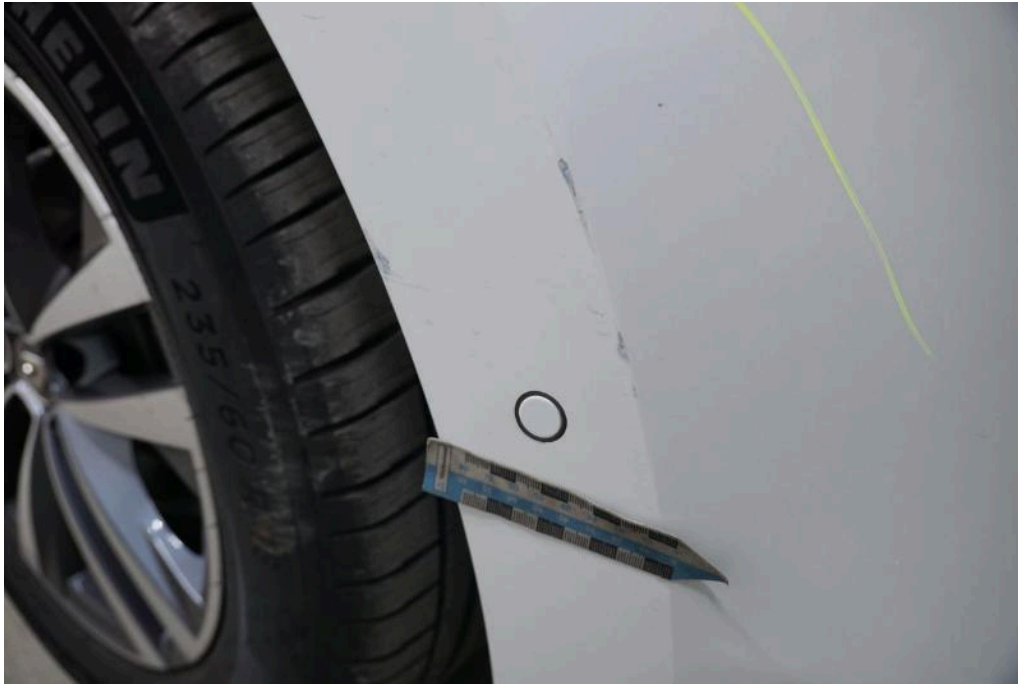
Bild 25 Fahrzeugfront Stoßfänger vorne verkratzt
