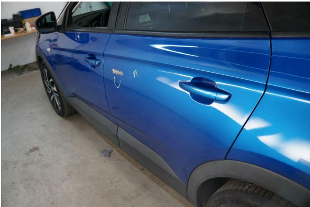
Bild 26 linke Seite Tür hinten links Kratzer Delle
