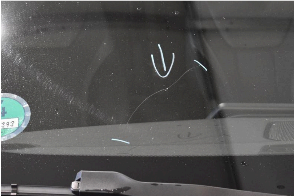
Bild 19 Fahrzeugfront Windschutzscheibe gerissen / eingerissen
