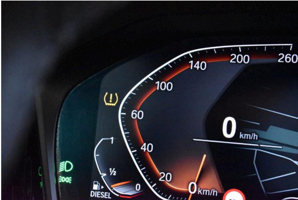
Bild 17 Systeme Reifendruckkontrollsystem aktiv / gestört
