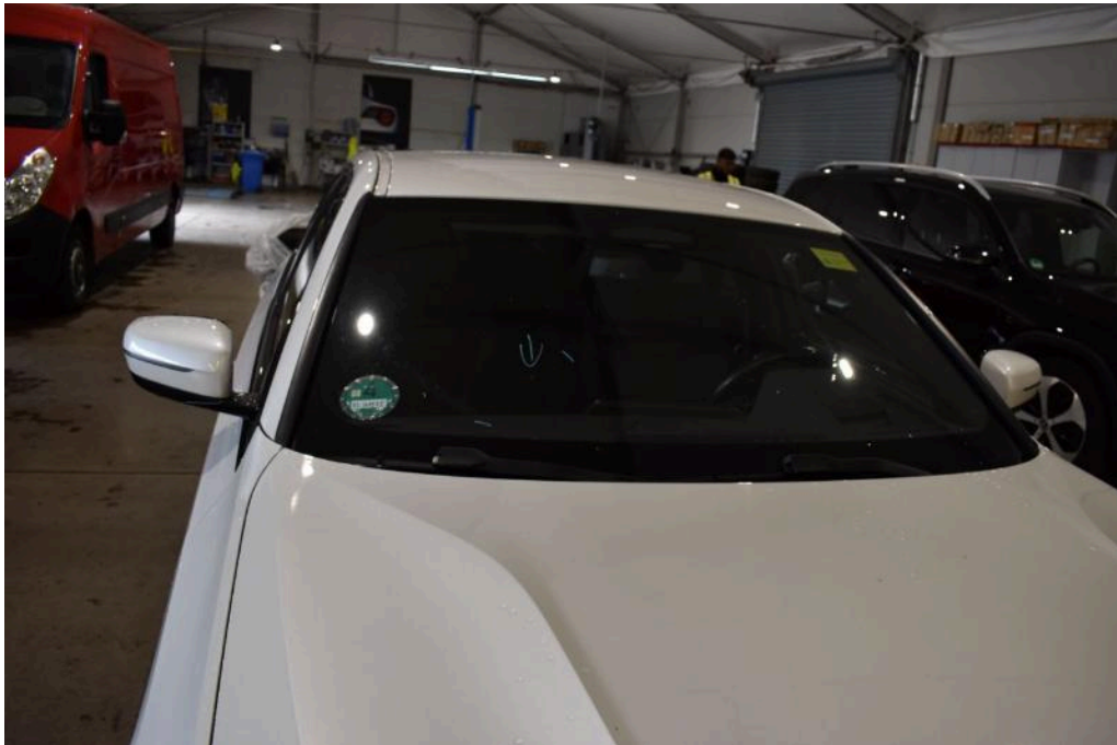
Bild 18 Fahrzeugfront Windschutzscheibe gerissen / eingerissen
