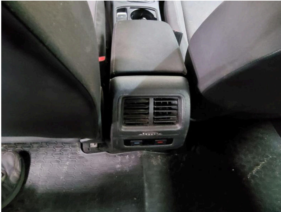
Bild 51 Innenraum Düsenbelüftung gebrochen
