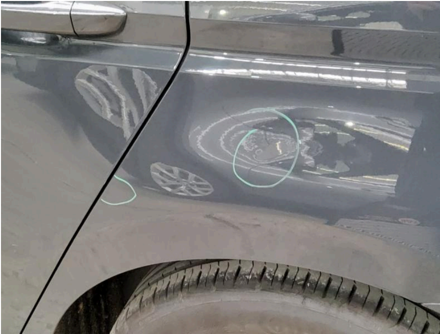
Bild 35 linke Seite Seitenwand hinten links Dellen Kratzer
