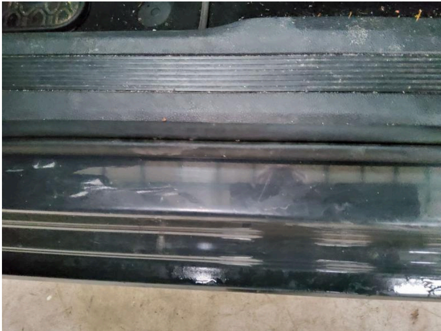
Bild 22 Innenraum Einstieg vorne links Kratzer
