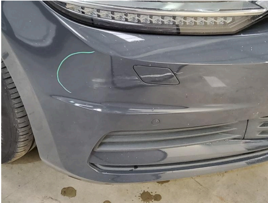
Bild 29 Fahrzeugfront Stoßfänger vorne Delle
