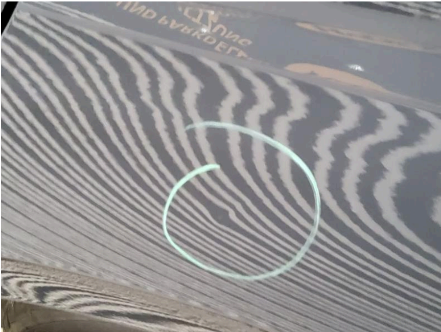
Bild 36 linke Seite Seitenwand hinten links Dellen Kratzer
