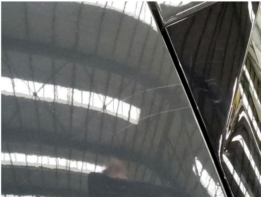
Bild 40 linke Seite Seitenwand hinten links Dellen Kratzer
