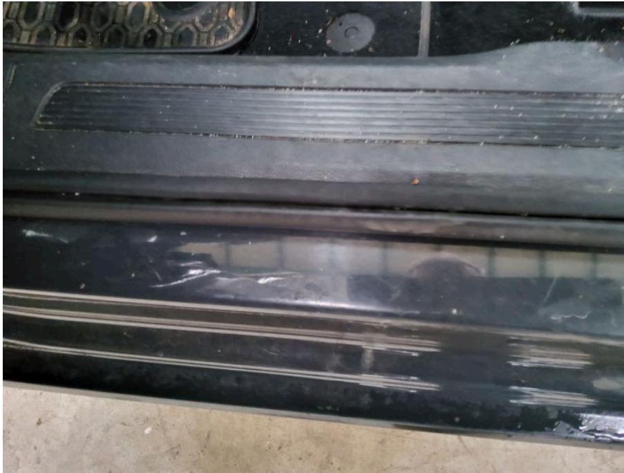
Bild 23 Innenraum Einstieg vorne links Kratzer
