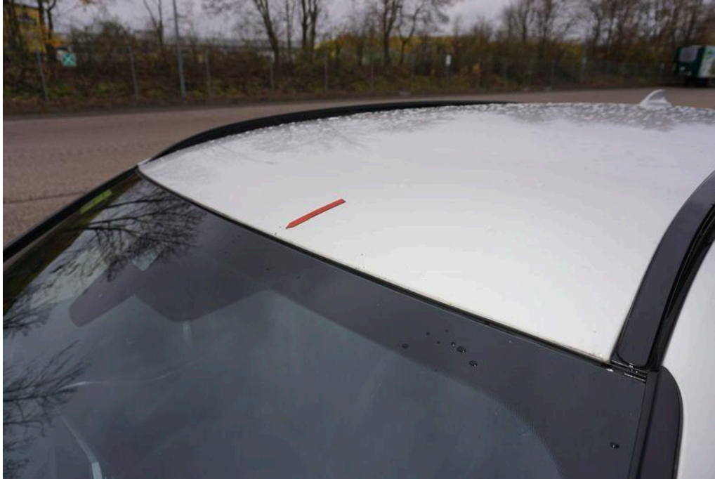
Bild 49 Dach Dachhaut vorn Steinschlag / -schläge
