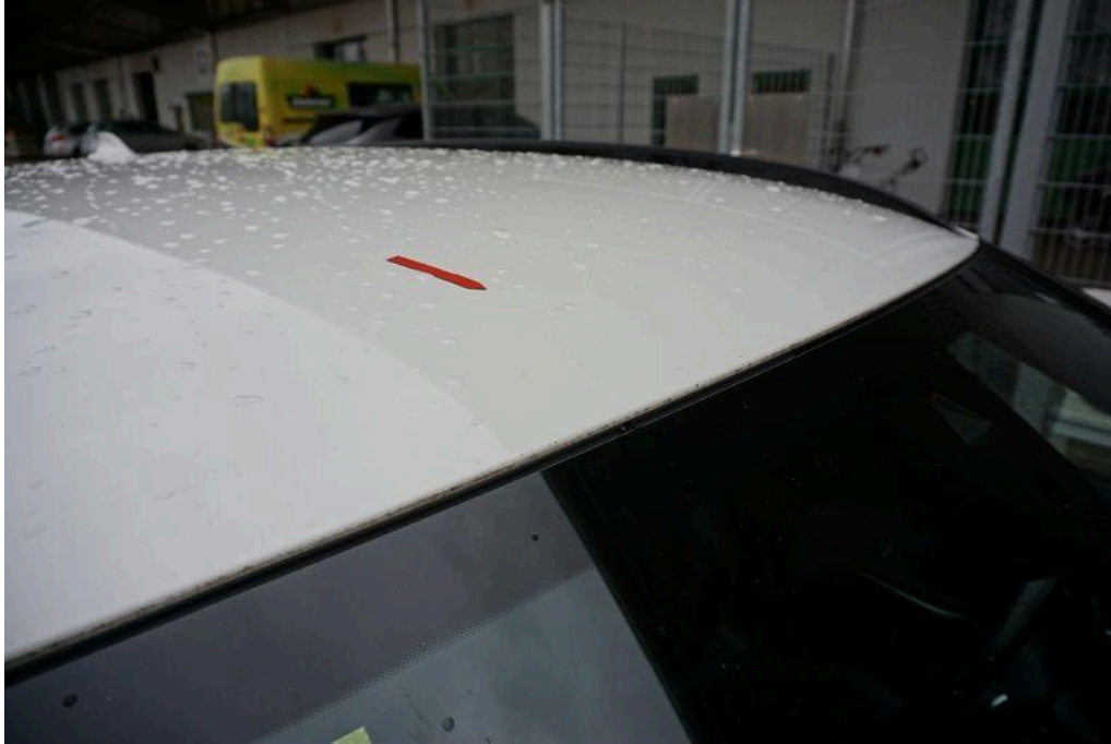
Bild 51 Dach Dachhaut vorn Steinschlag / -schläge
