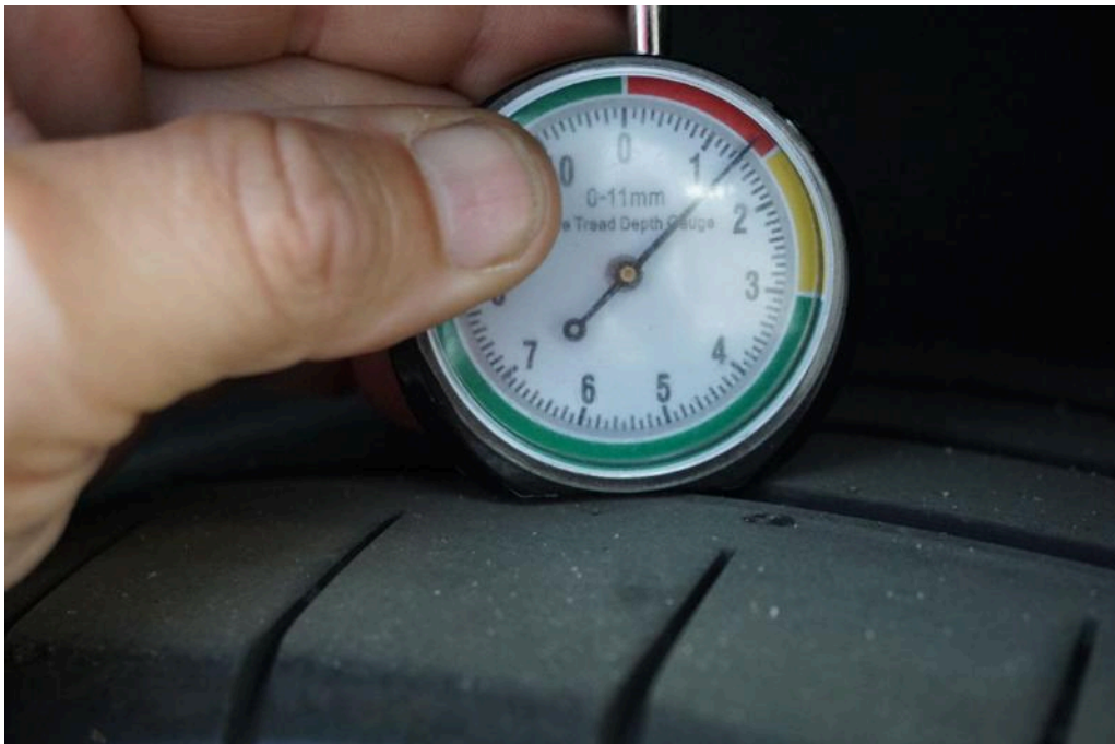
Bild 18 Hinterachse Reifen hinten rechts Reifen hinten links unter Mindestprofiltiefe
