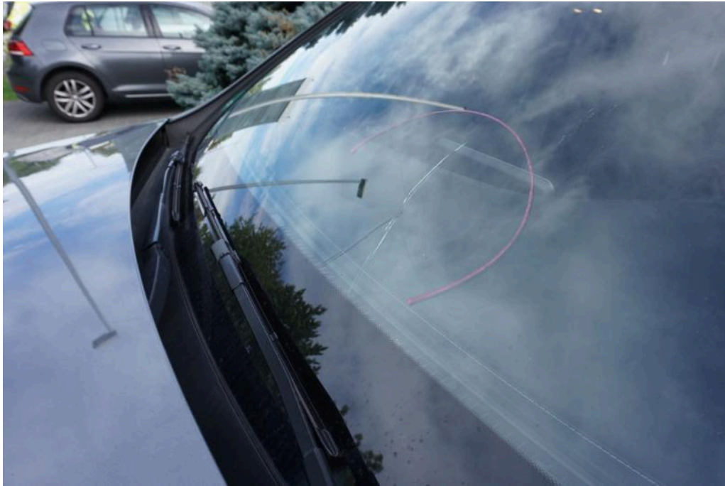
Bild 23 Fahrzeugfront Windschutzscheibe gerissen / eingerissen
