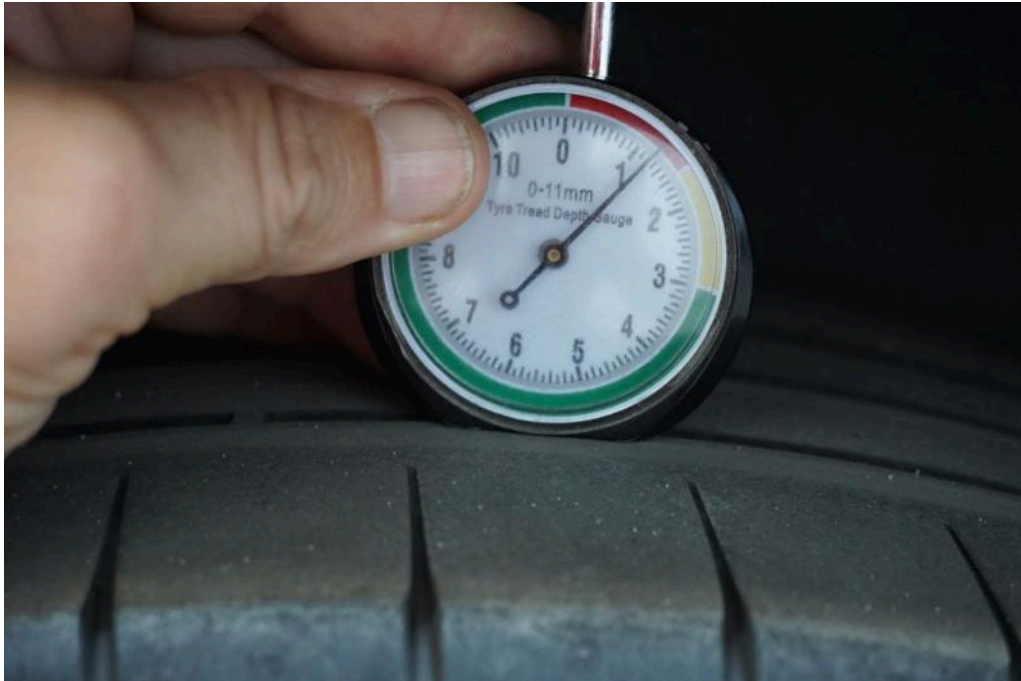
Bild 17 Hinterachse Reifen hinten rechts Reifen hinten links unter Mindestprofiltiefe
