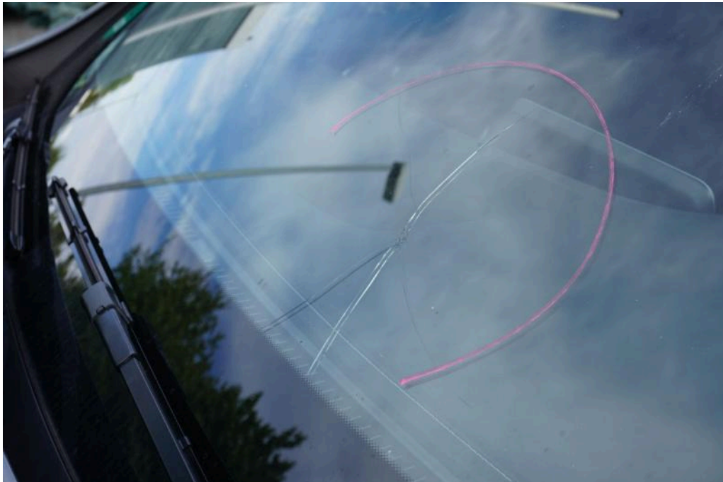
Bild 24 Fahrzeugfront Windschutzscheibe gerissen / eingerissen
