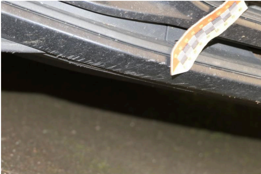
Bild 36 Fahrzeugfront Stoßfänger vorne verkratzt
