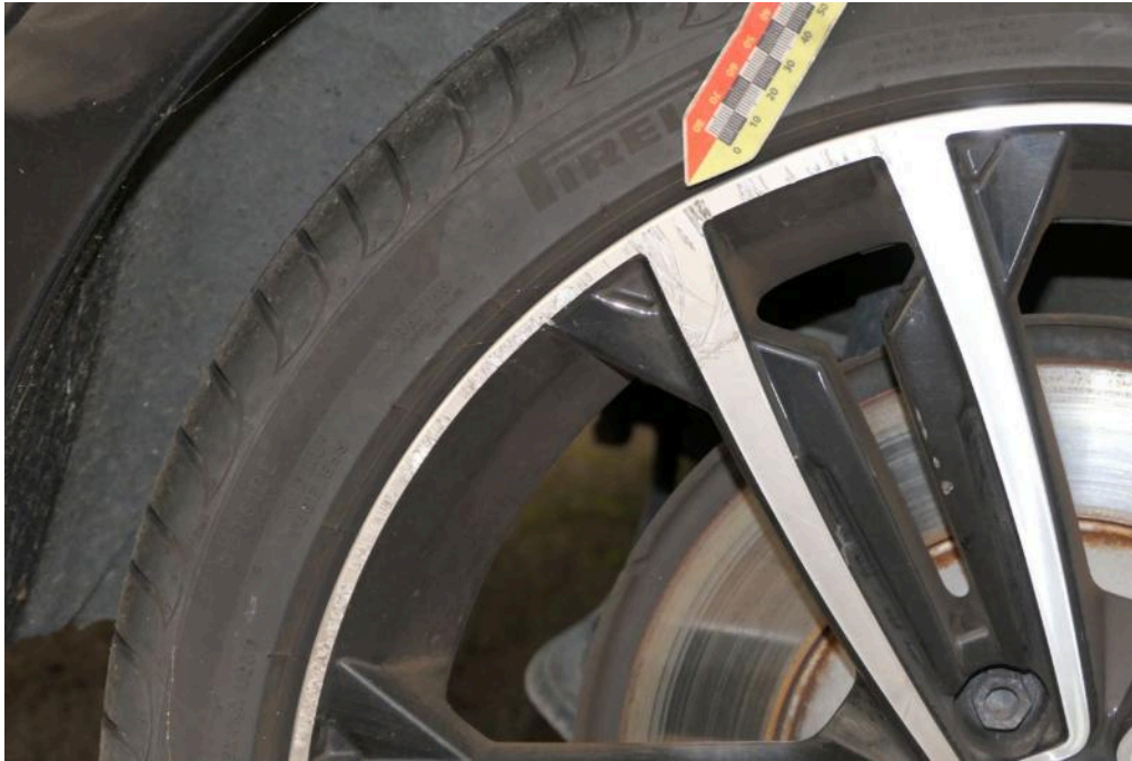
Bild 41 Hinterachse Felge hinten rechts stark zerkratzt
