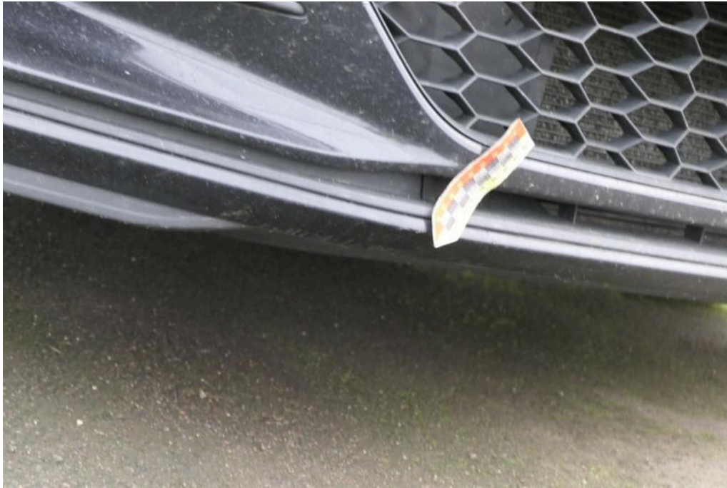
Bild 35 Fahrzeugfront Stoßfänger vorne verkratzt
