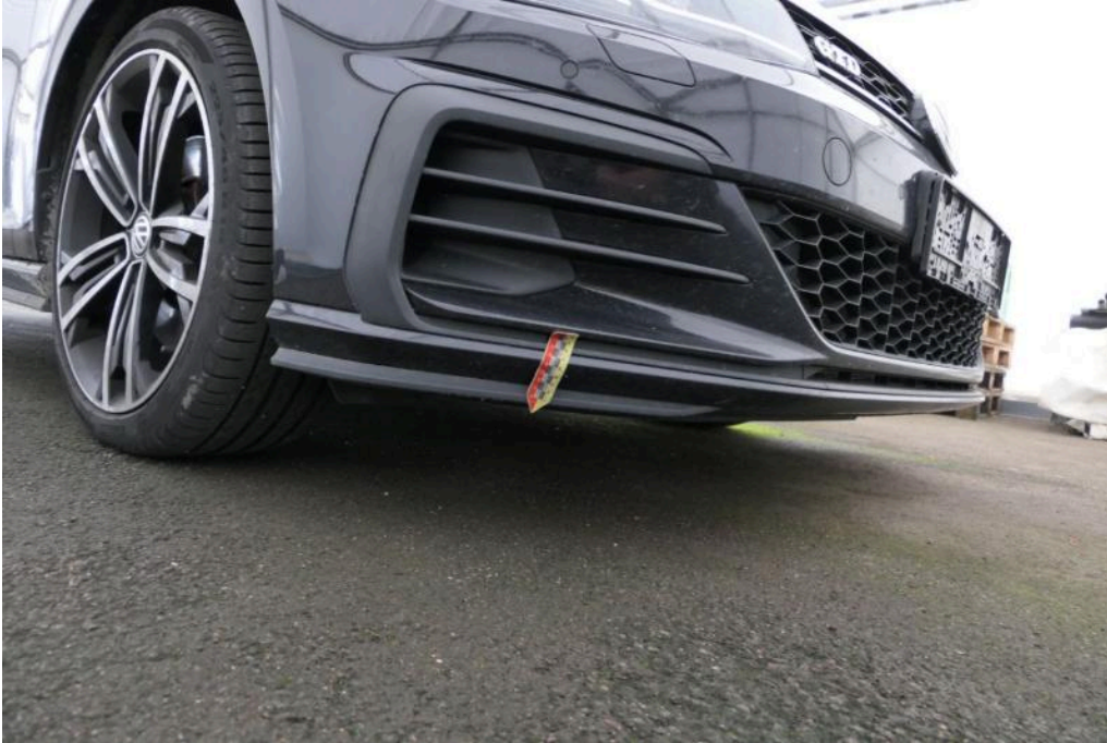
Bild 33 Fahrzeugfront Stoßfänger vorne verkratzt
