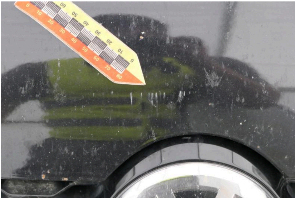
Bild 32 Fahrzeugfront Motorhaube Delle und Lackschaden
