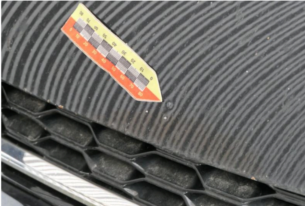
Bild 31 Fahrzeugfront Motorhaube Delle und Lackschaden
