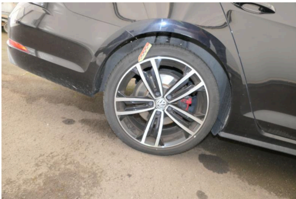
Bild 40 Hinterachse Felge hinten rechts stark zerkratzt
