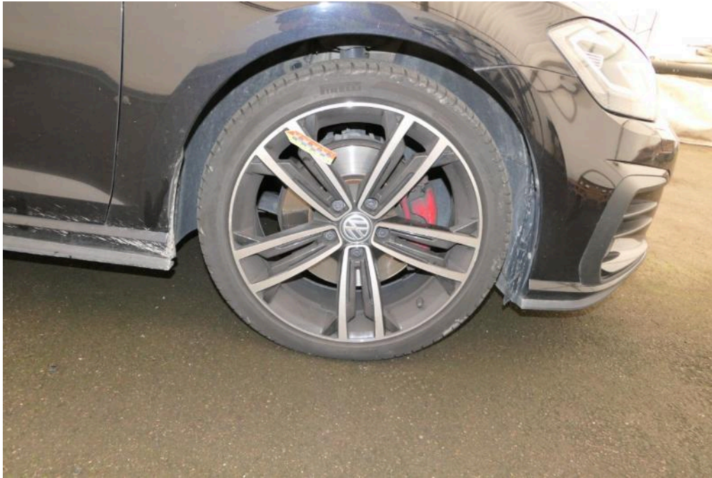
Bild 37 Vorderachse Felge vorne rechts Materialabtrag
