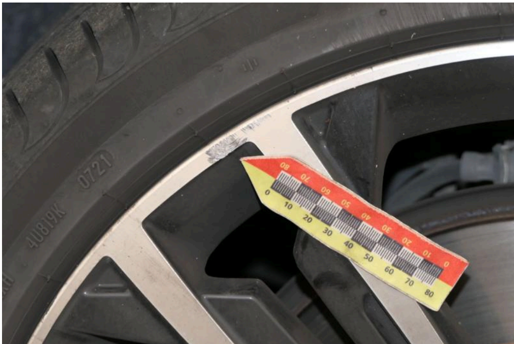
Bild 38 Vorderachse Felge vorne rechts Materialabtrag
