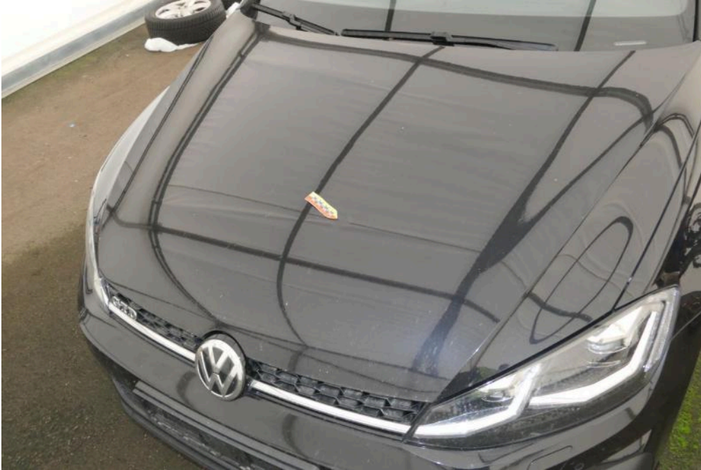
Bild 29 Fahrzeugfront Motorhaube Delle und Lackschaden
