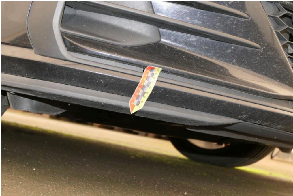
Bild 34 Fahrzeugfront Stoßfänger vorne verkratzt
