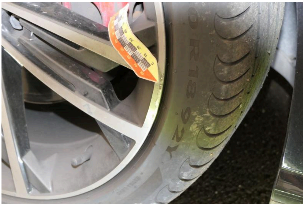
Bild 39 Vorderachse Felge vorne rechts Materialabtrag
