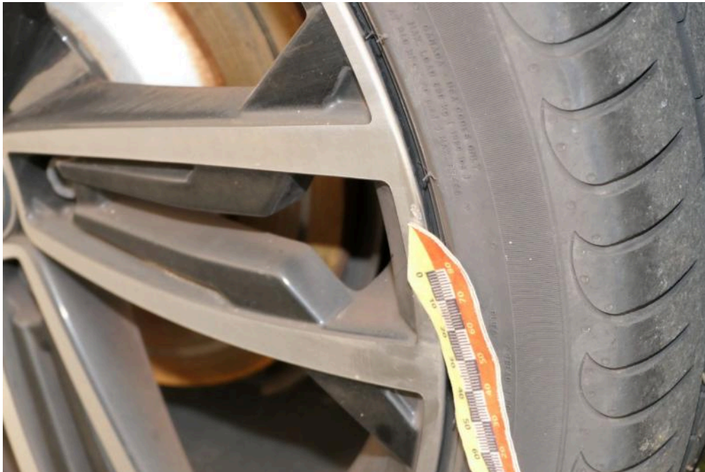
Bild 44 Hinterachse Felge hinten links zerkratzt
