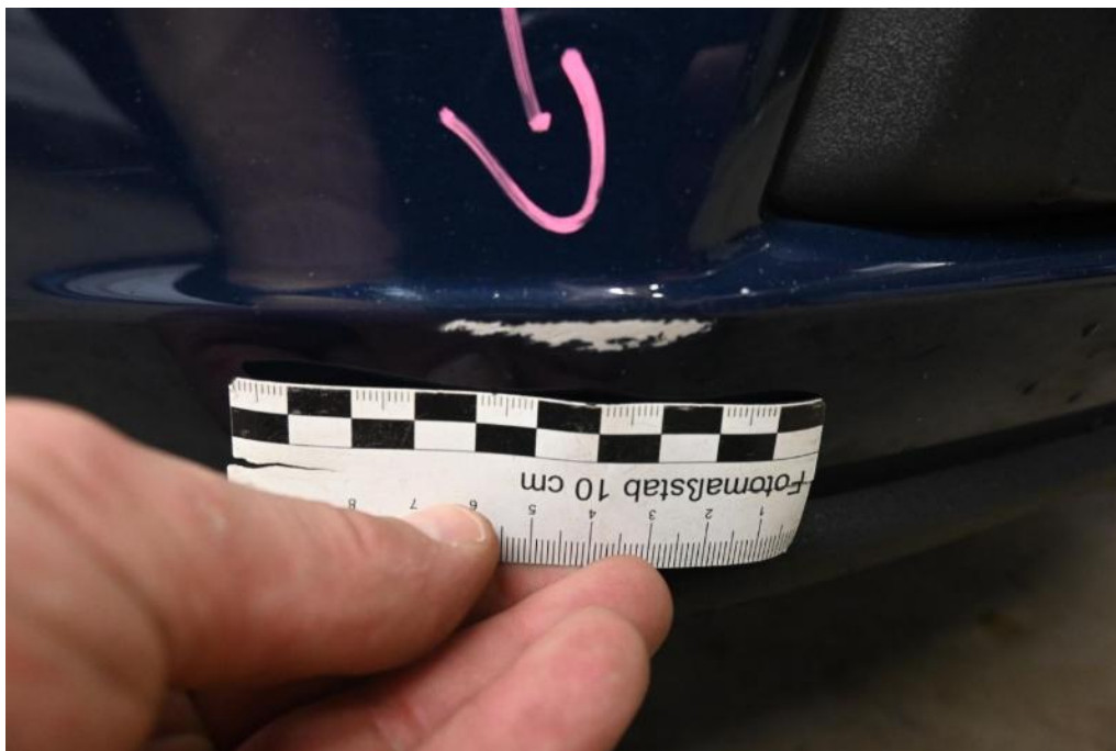
Bild 19 Fahrzeugfront Stoßfänger vorne Kratzer
