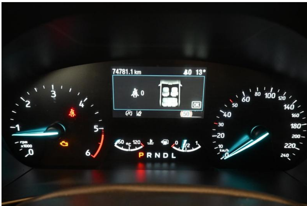
Bild 12: Tacho Systeme Motorkontrollleuchte aktiv / gestört
