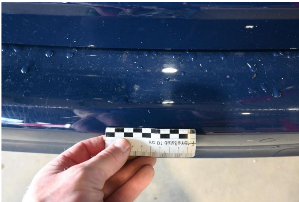
Bild 21 Fahrzeugheck Stoßfänger hinten verkratzt
