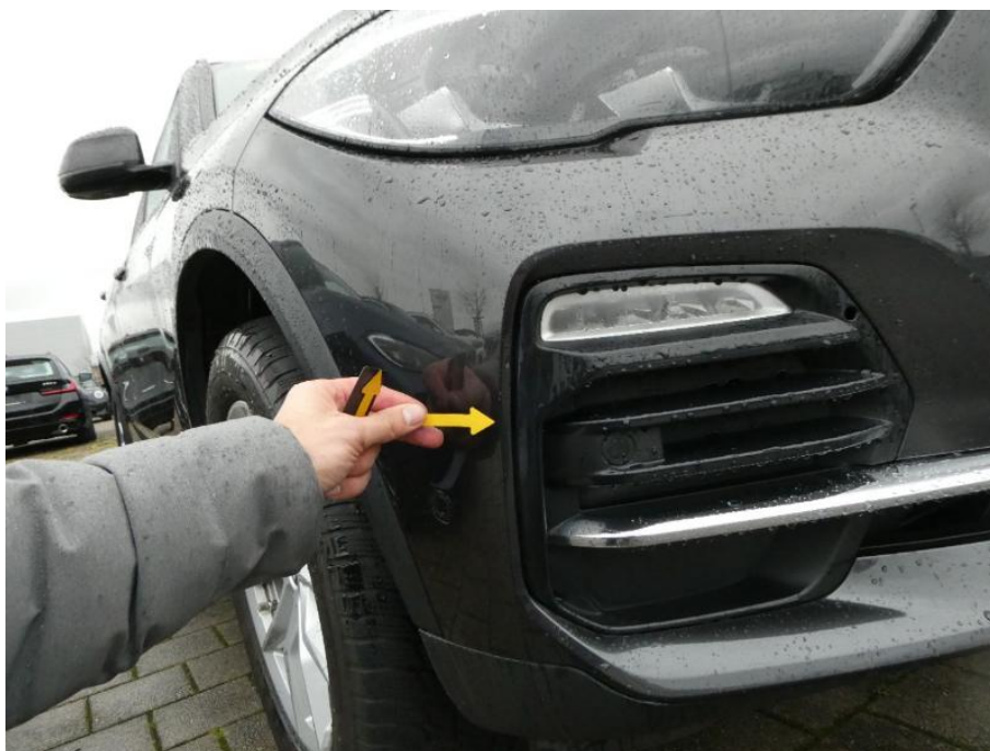
Bild 29 Fahrzeugfront Lüftungsgitter am Stossfänger Farbtonabweichung
