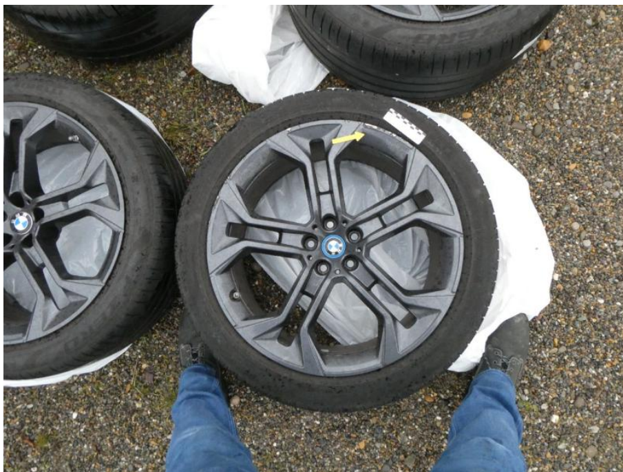
Bild 33 Fahrzeugzubehör 2. Reifensatz Felge hinten beschädigt mit Materialabtrag angestoßen
