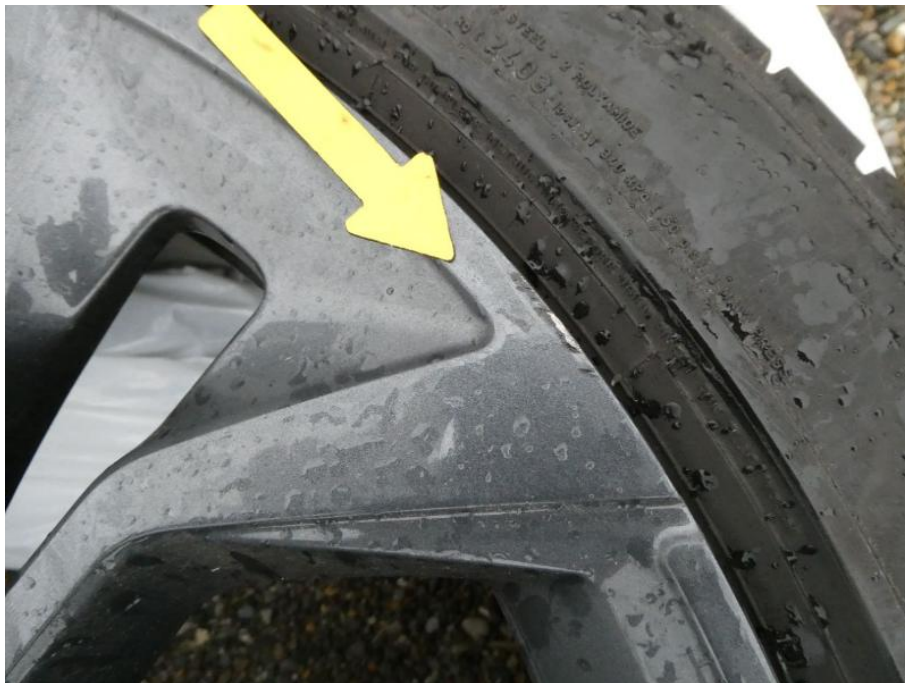
Bild 36 Fahrzeugzubehör 2. Reifensatz Felge vorn beschädigt mit Materialabtrag angestoßen
