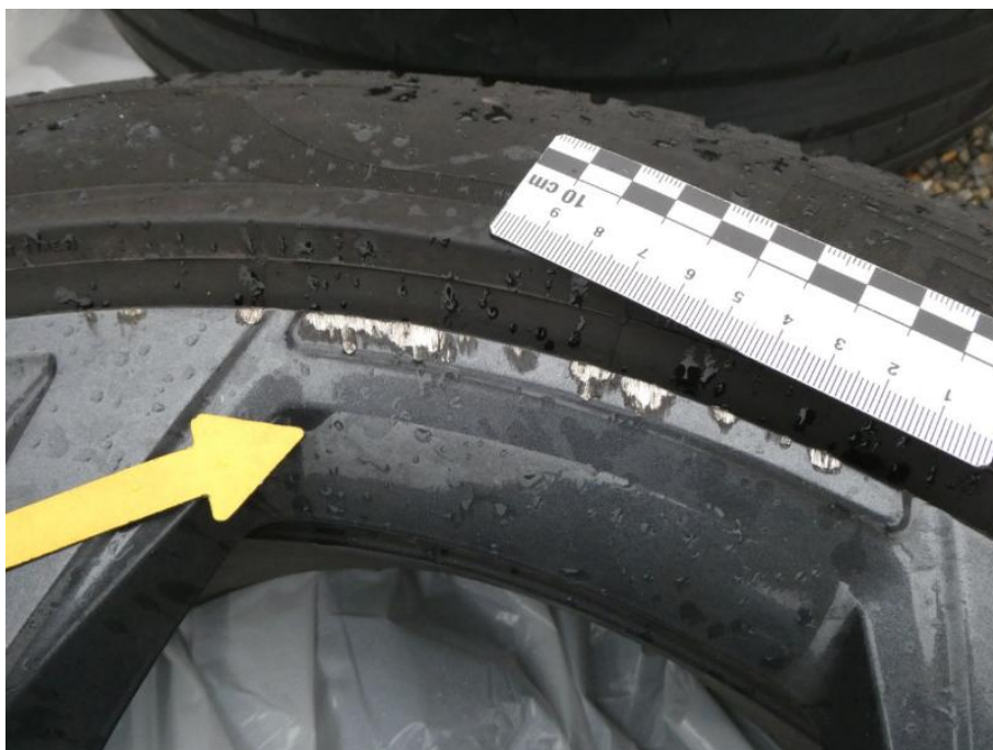
Bild 34 Fahrzeugzubehör 2. Reifensatz Felge hinten beschädigt mit Materialabtrag angestoßen
