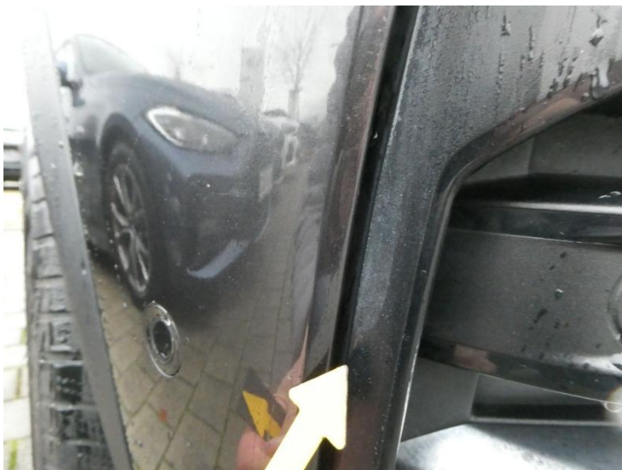
Bild 30 Fahrzeugfront Lüftungsgitter am Stossfänger Farbtonabweichung
