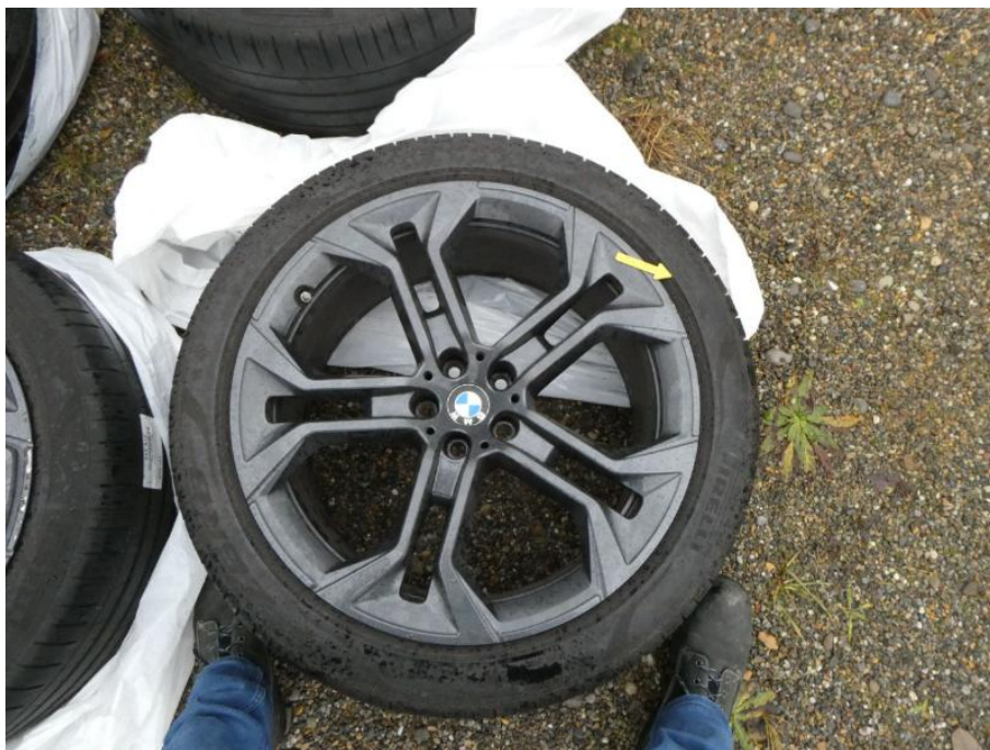
Bild 35 Fahrzeugzubehör 2. Reifensatz Felge vorn beschädigt mit Materialabtrag angestoßen
