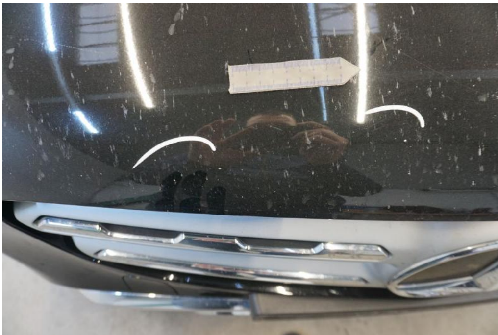
Bild 19 Fahrzeugfront Motorhaube Steinschlag / -schläge
