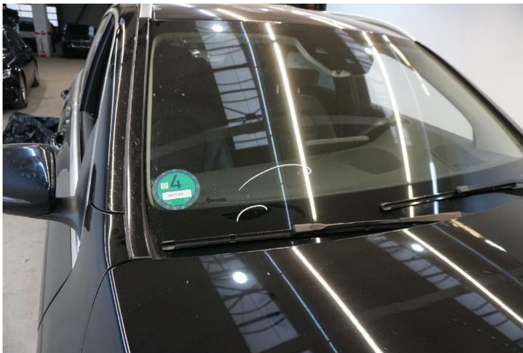
Bild 21 Fahrzeugfront Windschutzscheibe gerissen / eingerissen
