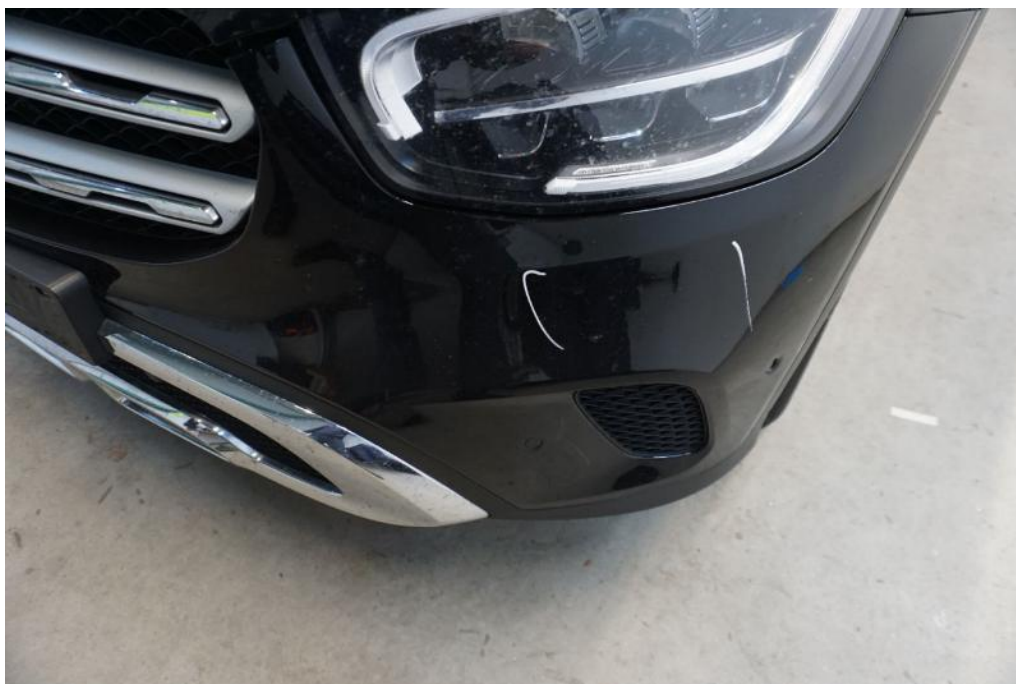
Bild 20 Fahrzeugfront Stoßfänger vorne Steinschlag / -schläge
