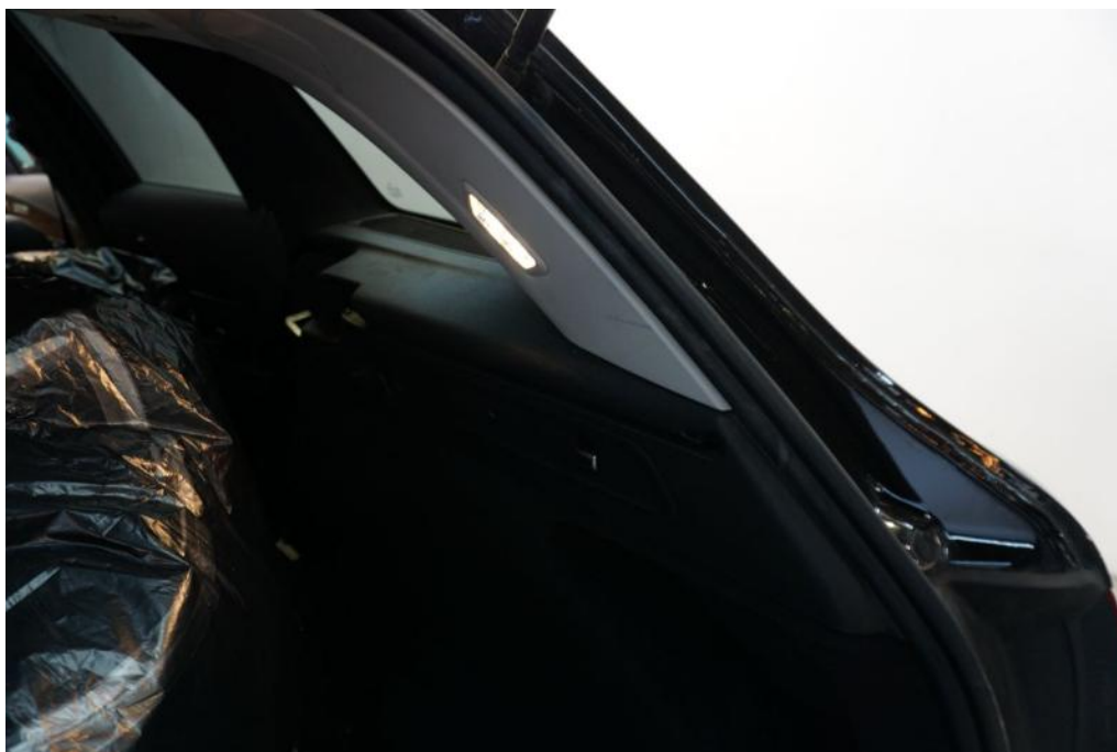
Bild 28 Innenraum Kofferraumverkleidung rechts verkratzt
