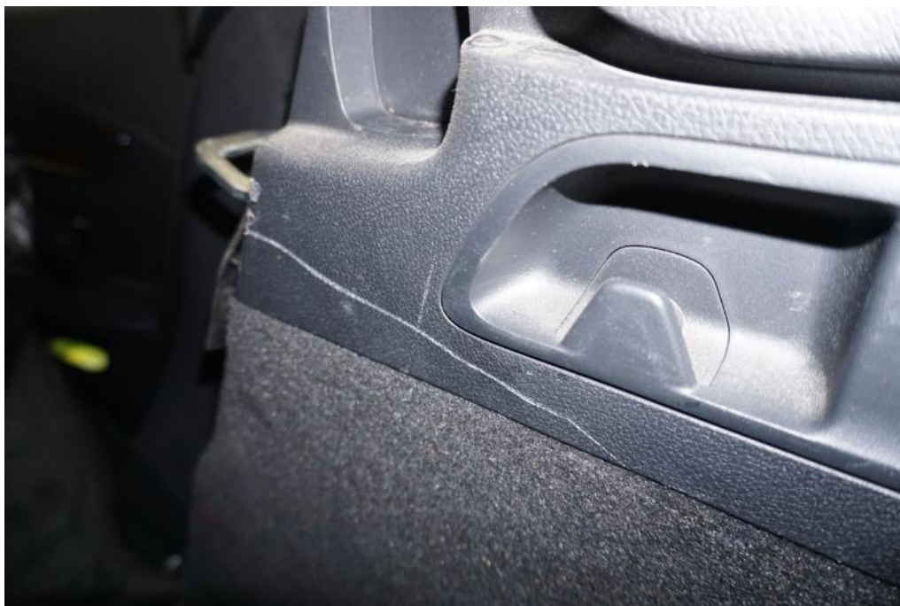
Bild 29 Innenraum Kofferraumverkleidung rechts verkratzt
