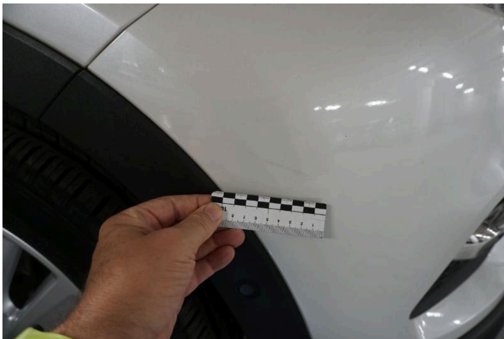
Bild 31 Fahrzeugfront Stoßfänger vorne Kratzer
