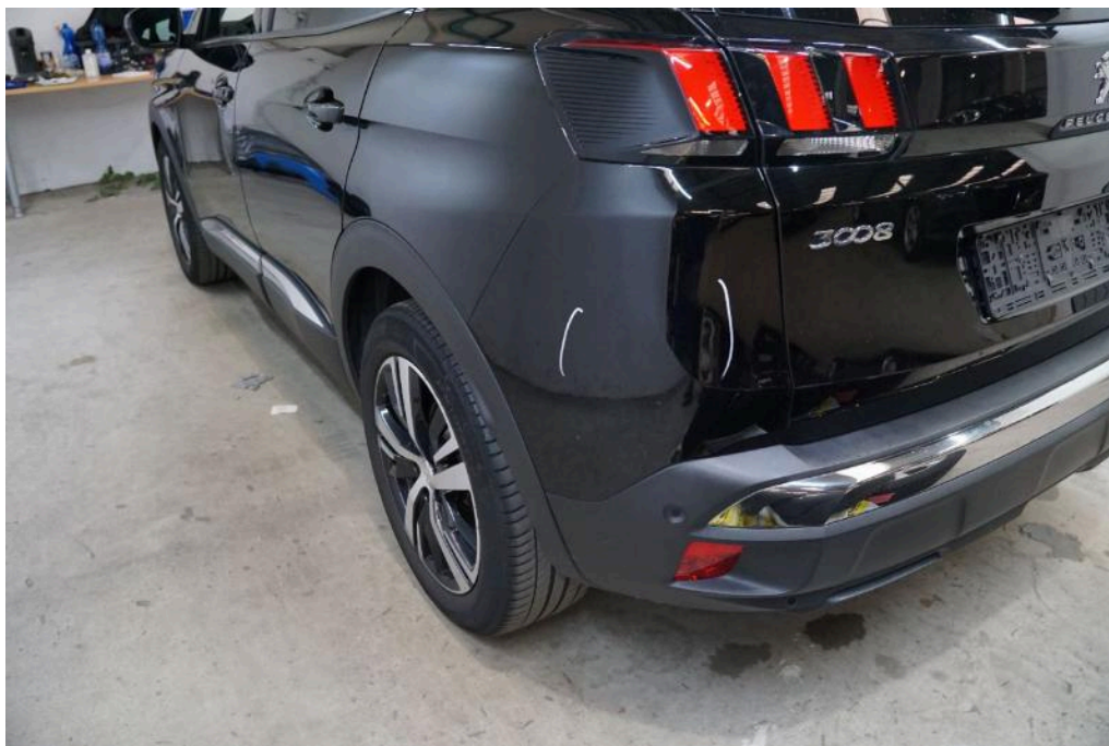
Bild 25 Fahrzeugheck Stoßfänger hinten verkratzt
