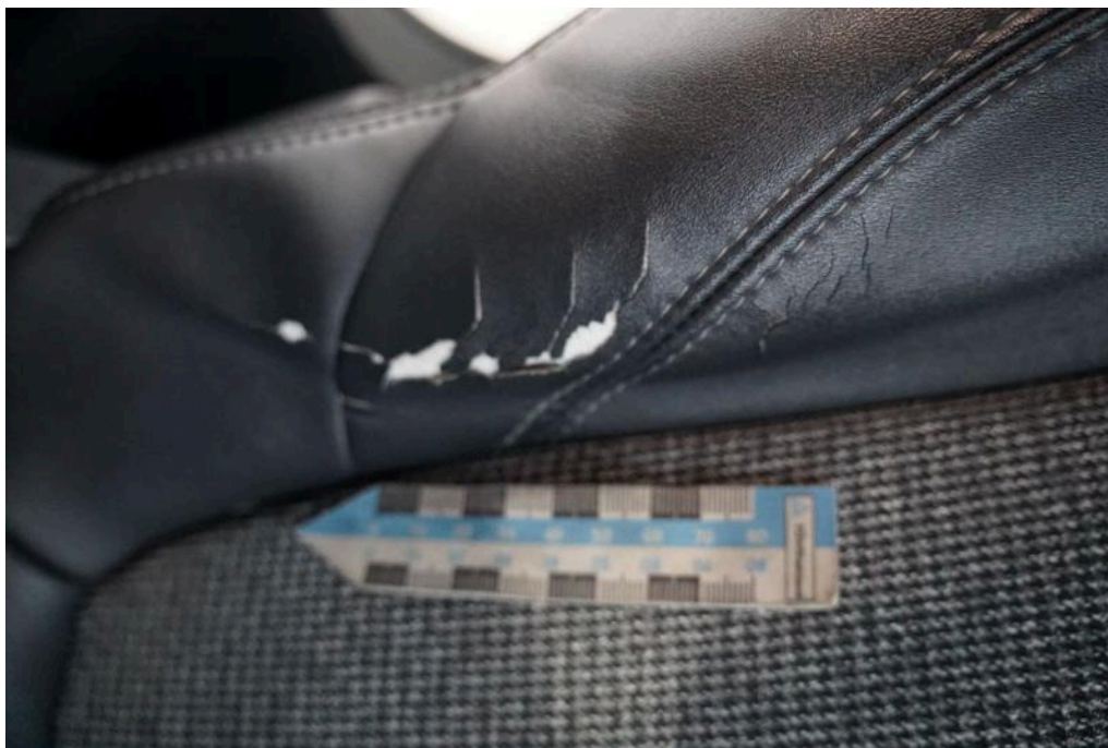
Bild 19 Innenraum Sitz vorn links gerissen / eingerissen
