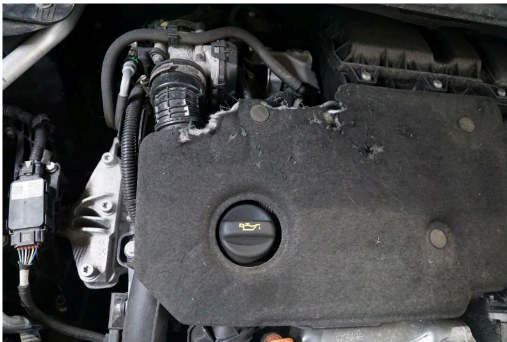
Bild 17 Motor Motorabdeckung beschädigt
