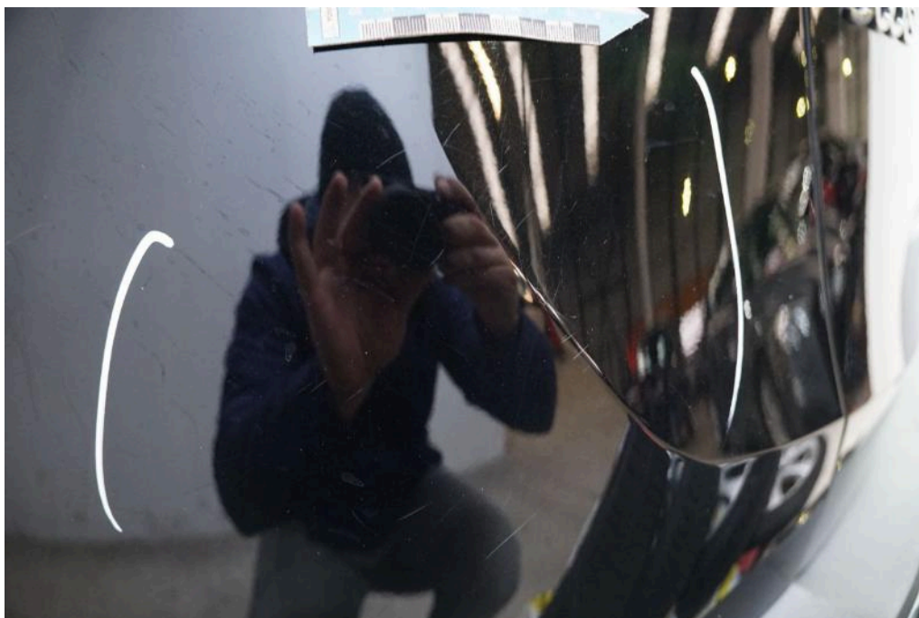
Bild 26 Fahrzeugheck Stoßfänger hinten verkratzt
