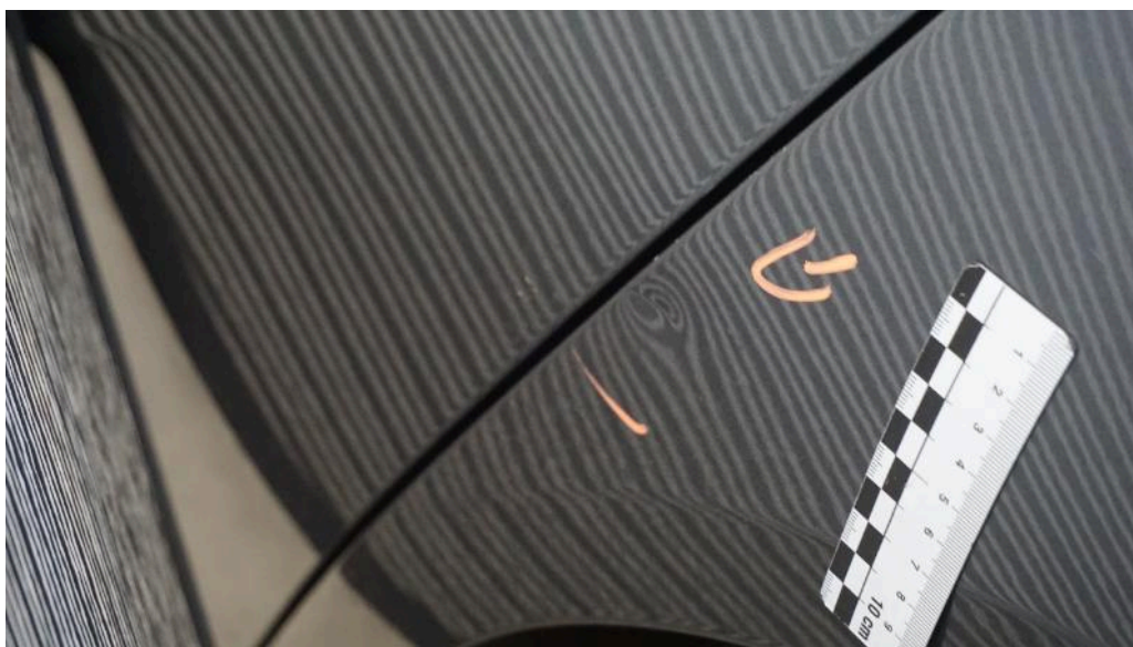
Bild 24 linke Seite Seitenwand hinten links Delle
