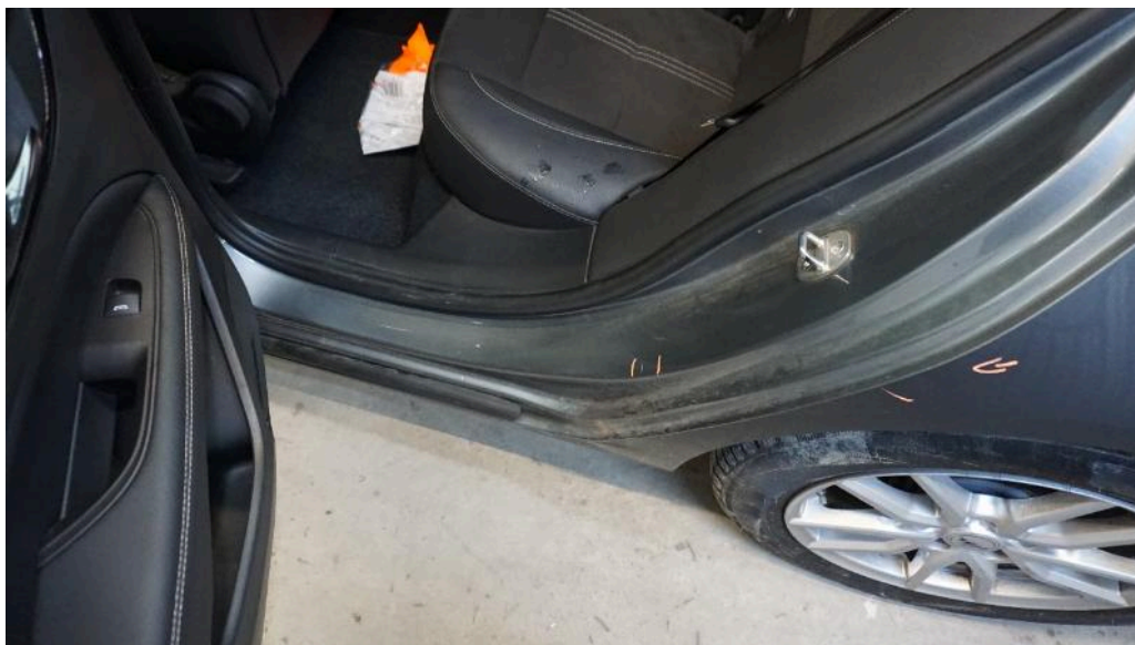
Bild 25 linke Seite Türeinstieg hinten links Kratzer, Innenraum Innenraum verschmutzt
