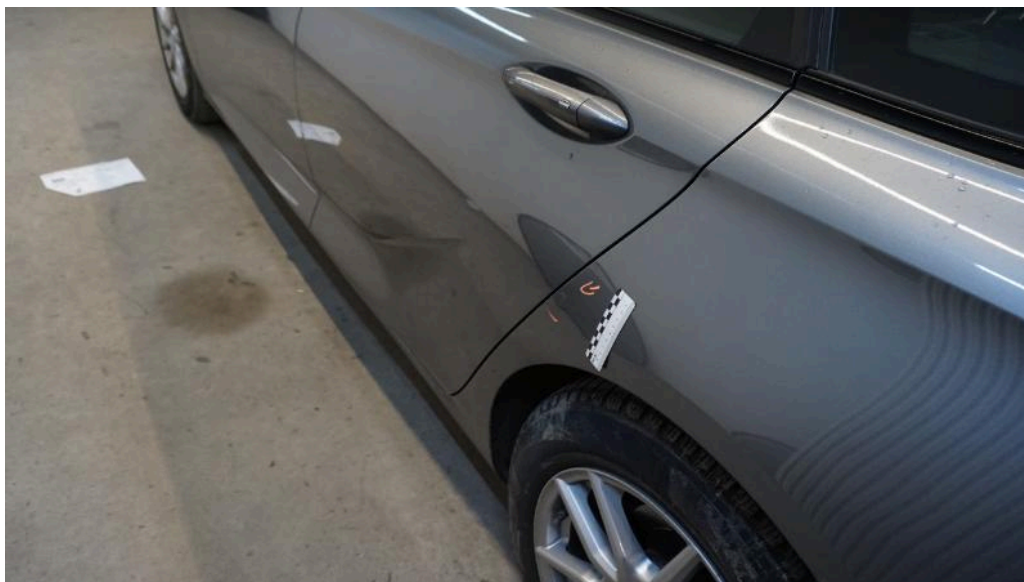
Bild 23 linke Seite Seitenwand hinten links Delle
