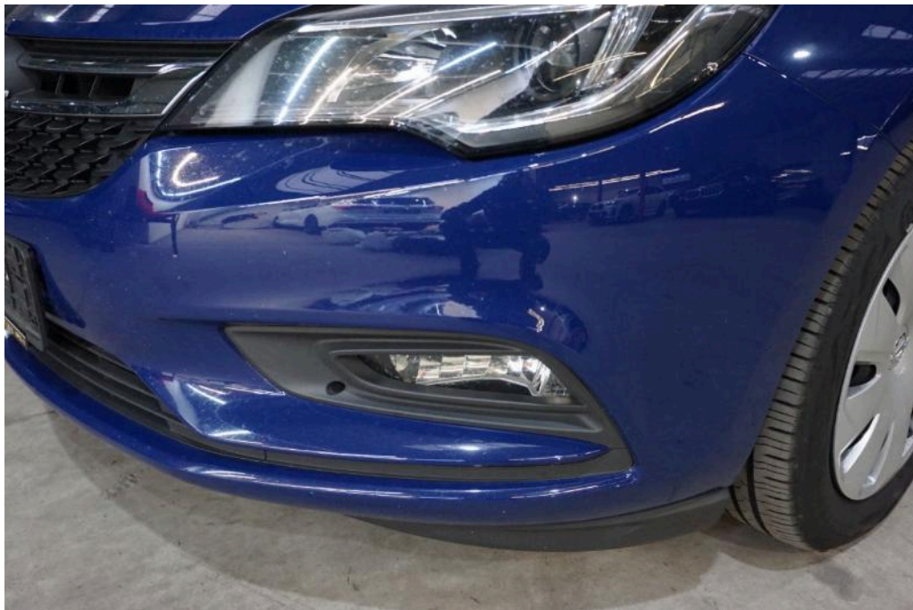
Bild 22 Fahrzeugfront Stoßfänger vorne Steinschlag / -schläge
