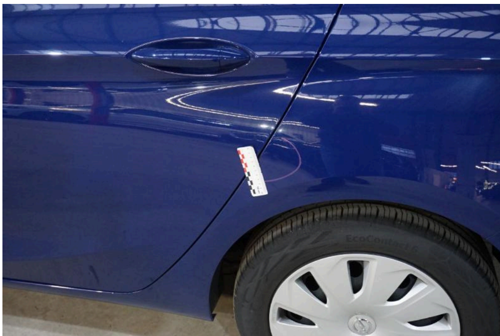
Bild 20 linke Seite Seitenwand hinten links Delle
