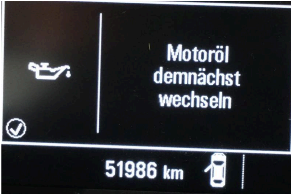
Bild 17 Wartung/Prüfung Ölwechsel Motor Wartung erforderlich – Kostenerweiterung möglich fällig
