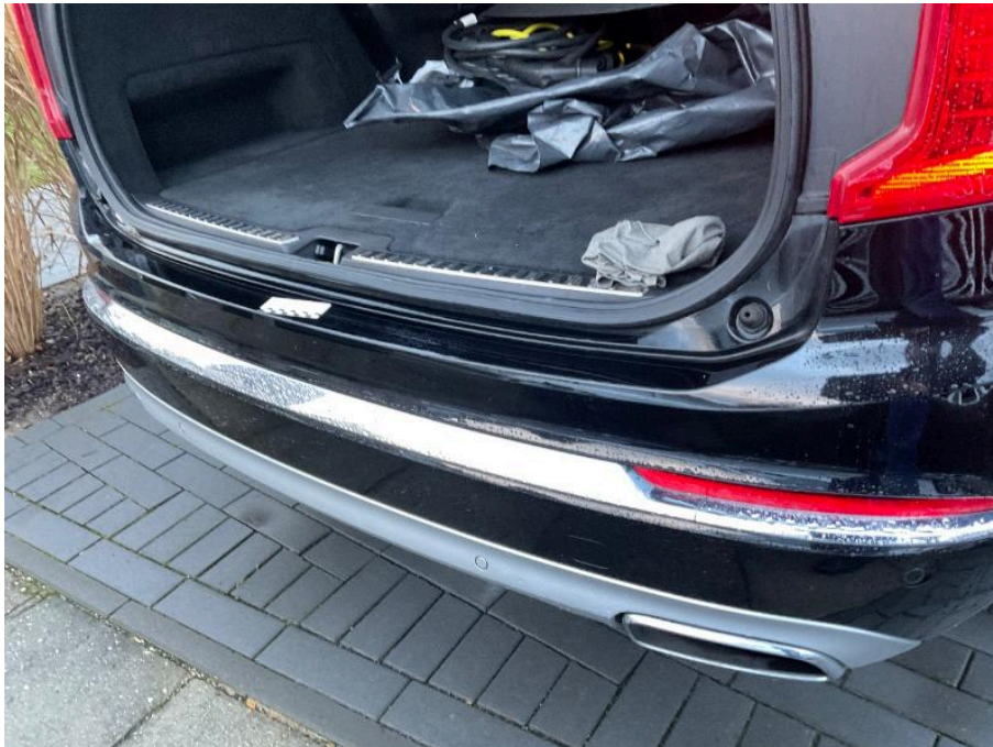
Bild 20 Fahrzeugheck Stoßfänger hinten Kratzer
