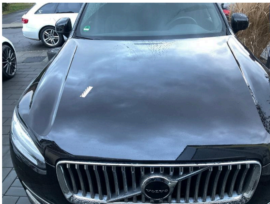
Bild 18 Fahrzeugfront Motorhaube Delle drücken, Kostenausweitung möglich Delle
