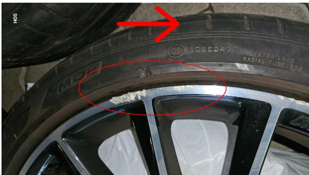
Bild 20 Fahrzeugzubehör 2. Reifensatz 1x Felge und Reifen beschädigt fehlt
