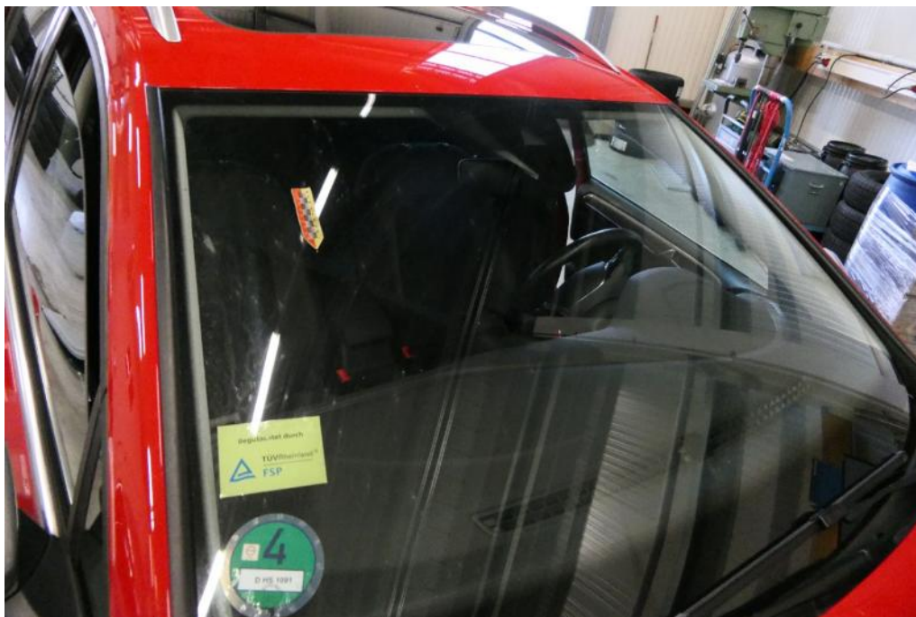
Bild 45 Fahrzeugfront Frontscheibe mit Regensensor Abplatzer
