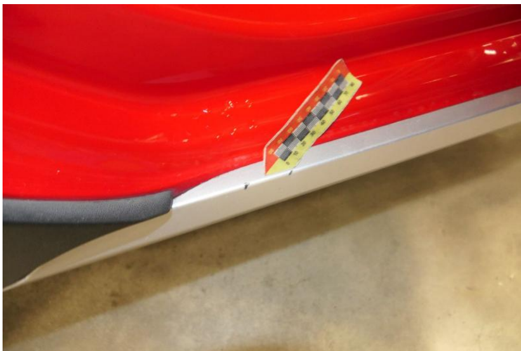
Bild 38 rechte Seite Schwellerverkleidung rechts Kratzer
