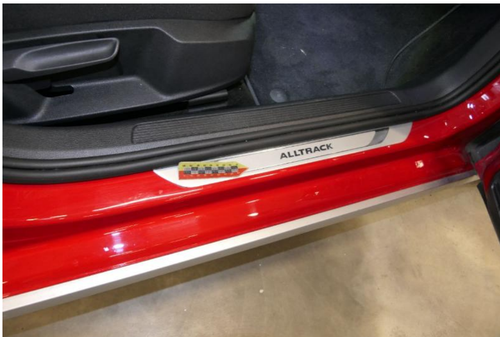
Bild 41 Innenraum Türeinstieg-Verkleidung vorne rechts Gebrauchsspuren
