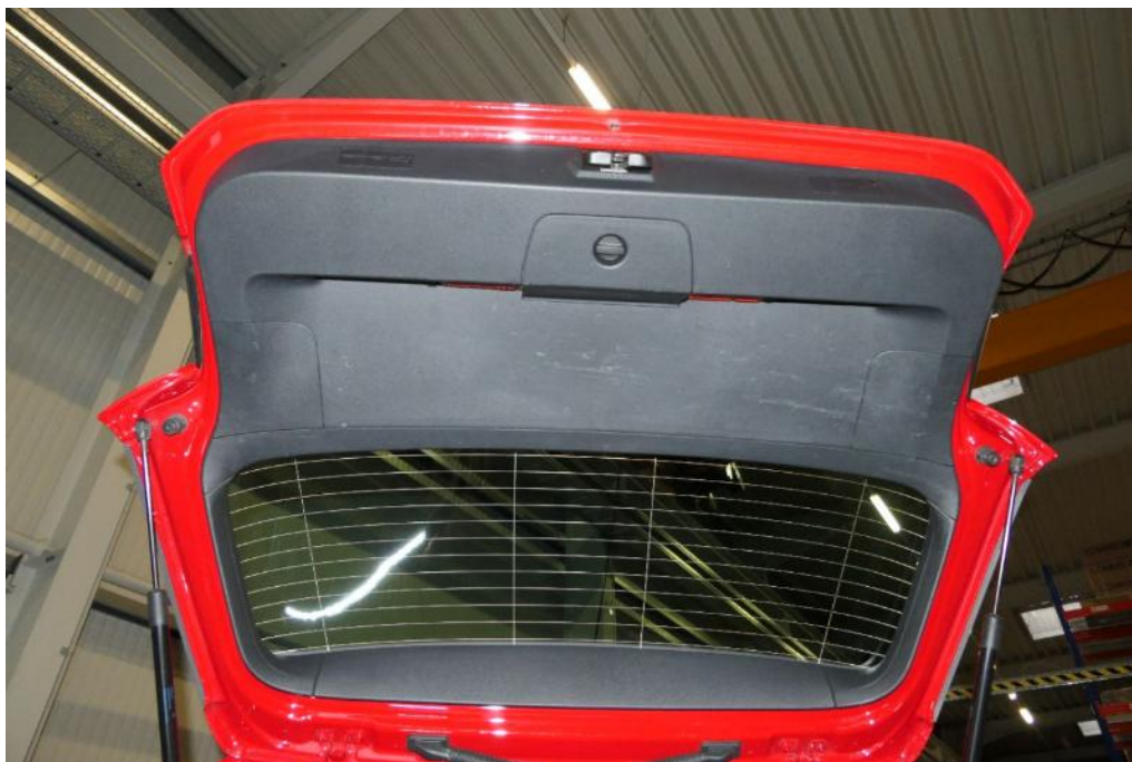
Bild 18 Innenraum Heckklappenverkleidung verkratzt
