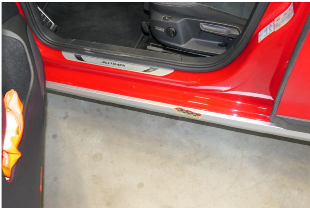
Bild 29 linke Seite Schwellerverkleidung links Kratzer
