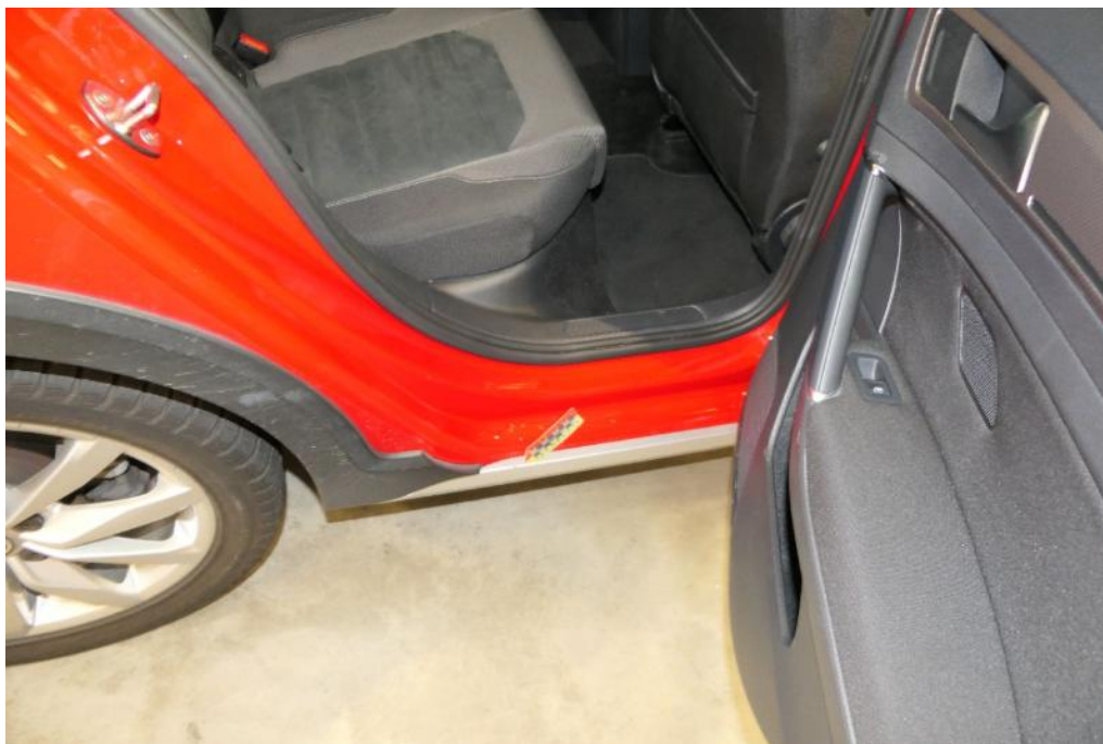
Bild 37 rechte Seite Schwellerverkleidung rechts Kratzer
