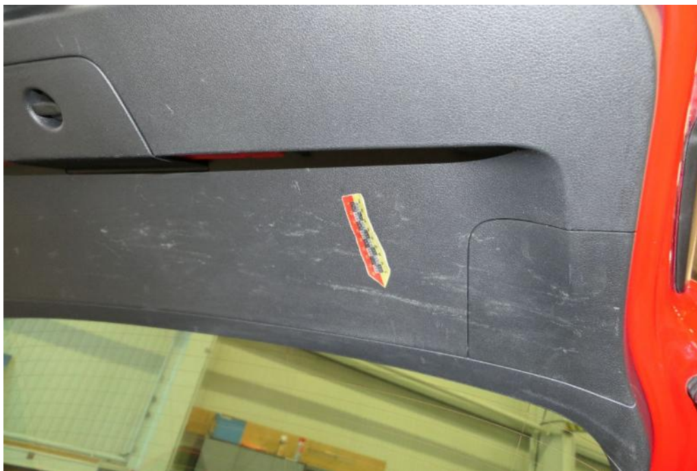
Bild 19 Innenraum Heckklappenverkleidung verkratzt
