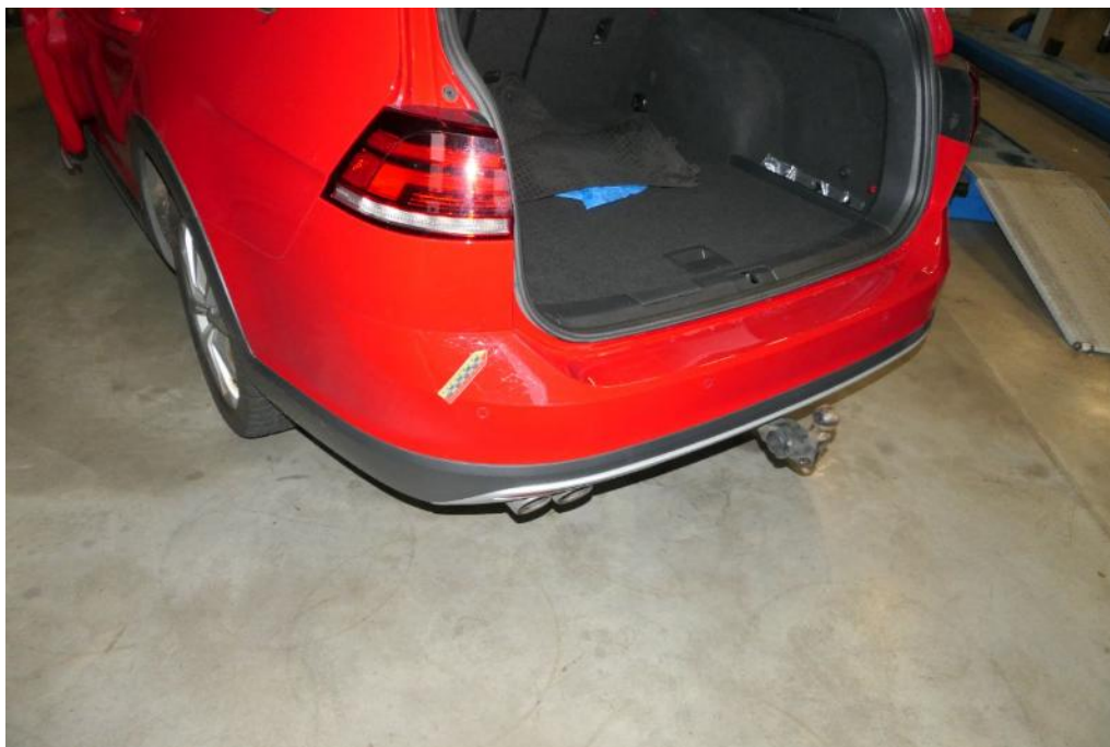
Bild 35 Fahrzeugheck Stoßfänger hinten verkratzt
