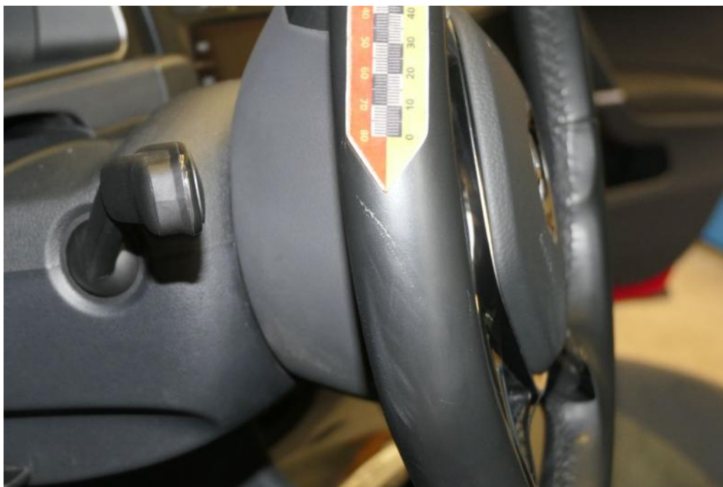
Bild 24 Innenraum Lenkrad Kratzer Gebrauchsspuren
