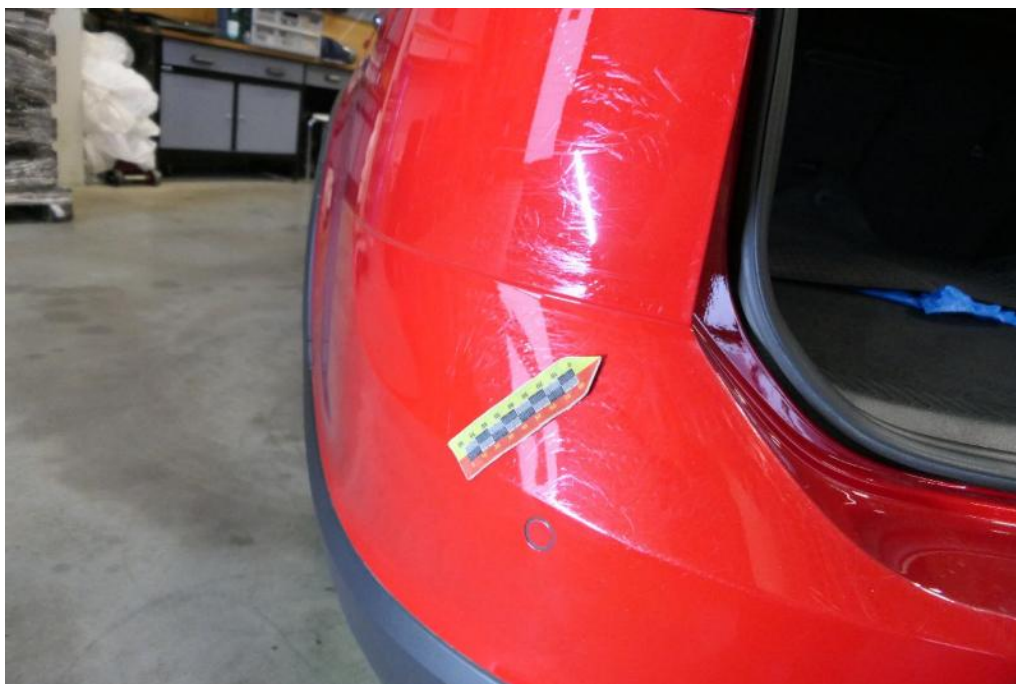
Bild 36 Fahrzeugheck Stoßfänger hinten verkratzt
