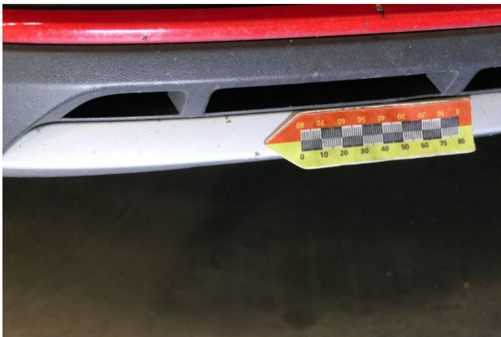
Bild 44 Fahrzeugfront Frontspoiler Steinschlag
