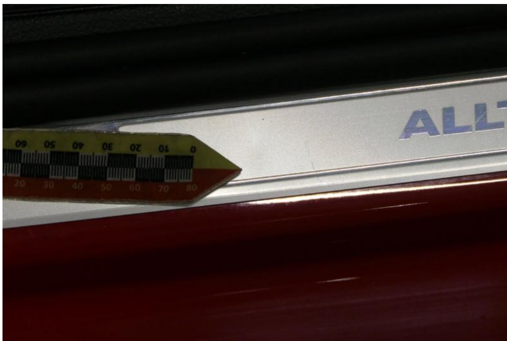
Bild 42 Innenraum Türeinstieg-Verkleidung vorne rechts Gebrauchsspuren
