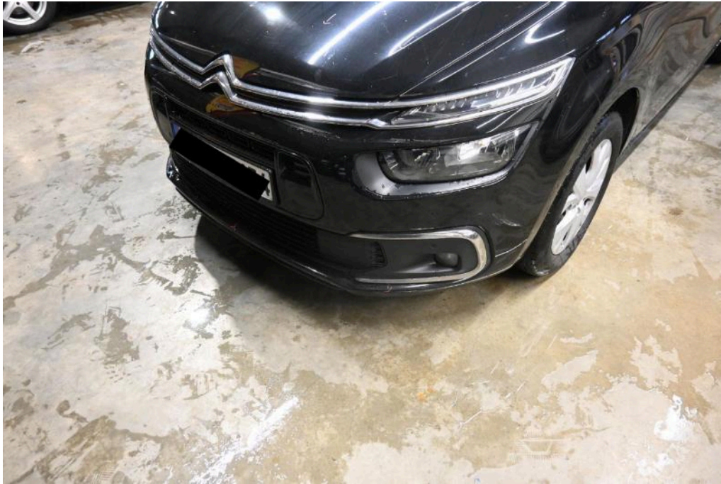
Bild 21 Fahrzeugfront Stoßfänger vorne verkratzt - Smart Repair + Spoiler unten Mitte ( erneuern ) Anbauteile -- verkratzt
