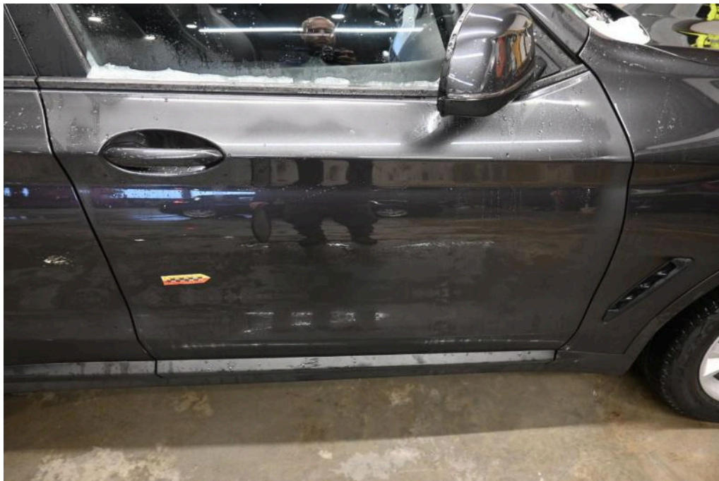
Bild 18 rechte Seite Tür vorne rechts Delle
