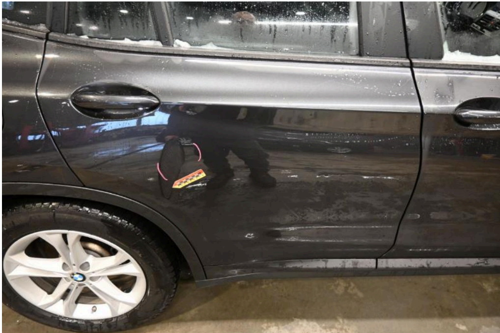
Bild 20 rechte Seite Tür hinten rechts Beule + Delle
