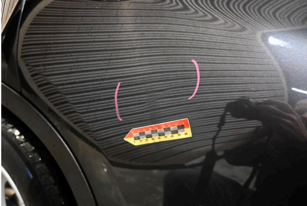
Bild 21 rechte Seite Tür hinten rechts Beule + Delle
