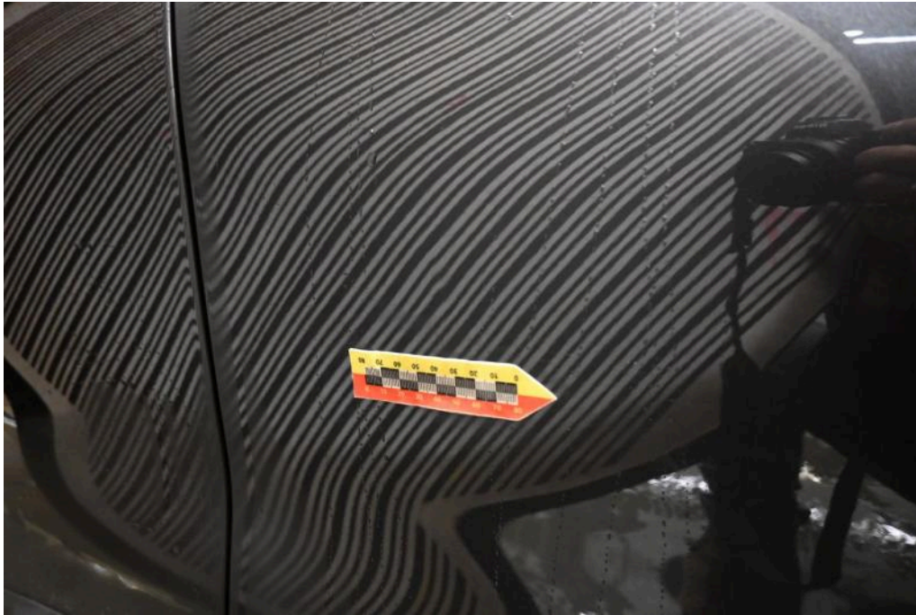
Bild 19 rechte Seite Tür vorne rechts Delle
