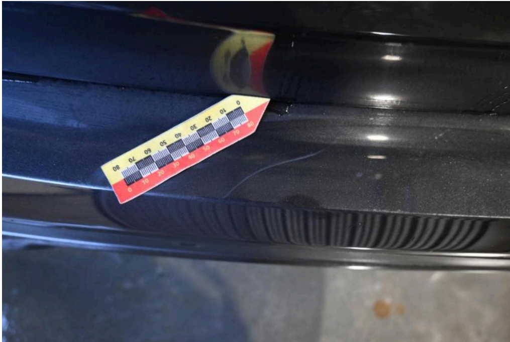
Bild 27 Fahrzeugheck Stoßfänger hinten Oberflächlicher Kratzer
