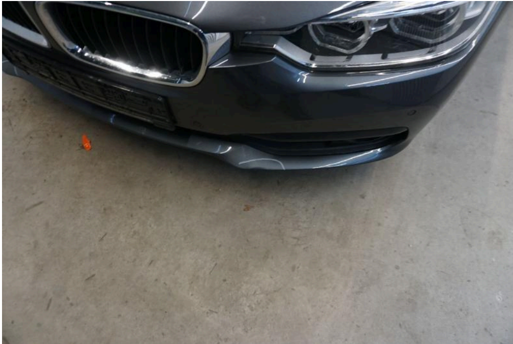
Bild 17 Fahrzeugfront Stoßfänger vorne gestaucht
