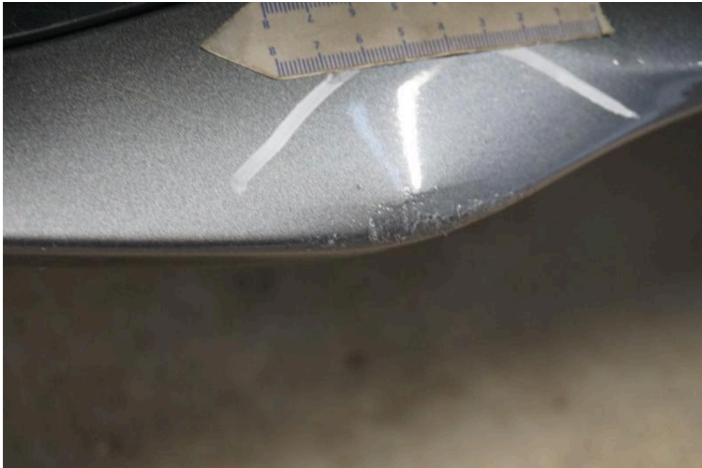
Bild 20 Fahrzeugfront Stoßfänger vorne gestaucht
