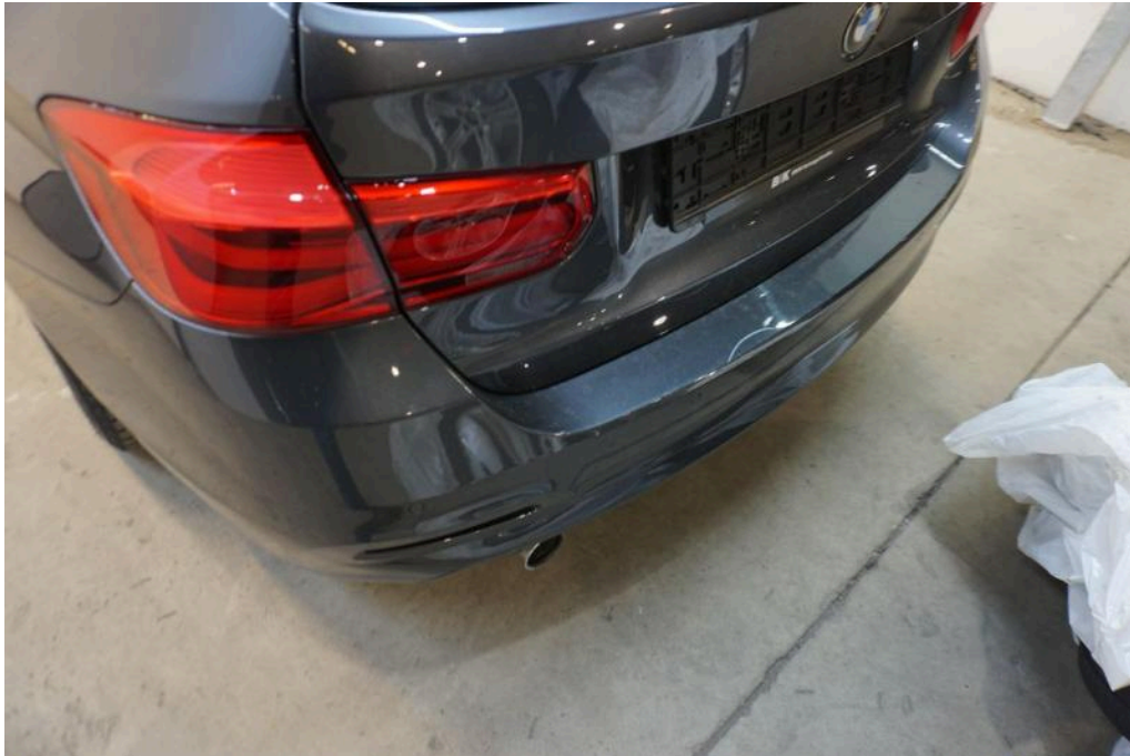
Bild 25 Fahrzeugheck Stoßfänger hinten Kratzer
