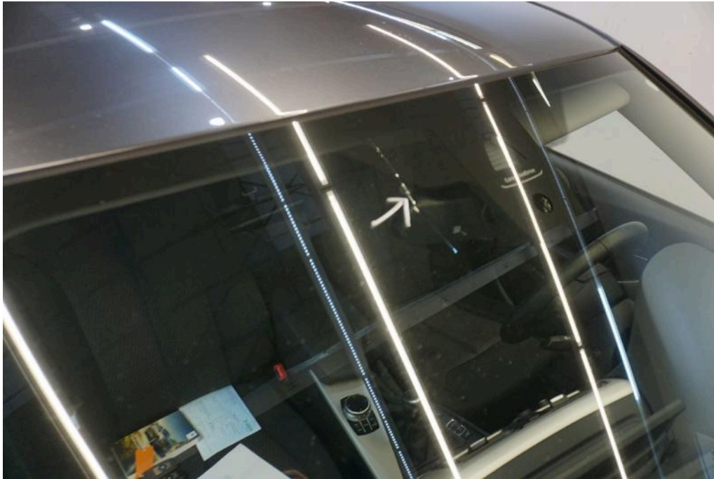
Bild 21 Fahrzeugfront Windschutzscheibe gerissen / eingerissen
