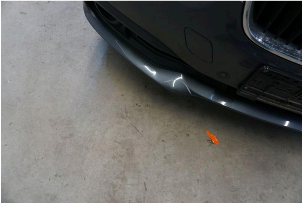
Bild 19 Fahrzeugfront Stoßfänger vorne gestaucht
