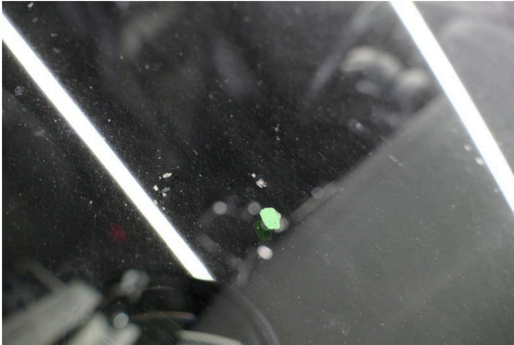
Bild 63 Fahrzeugfront Frontscheibe mit Regensensor Steinschlag / -schläge
