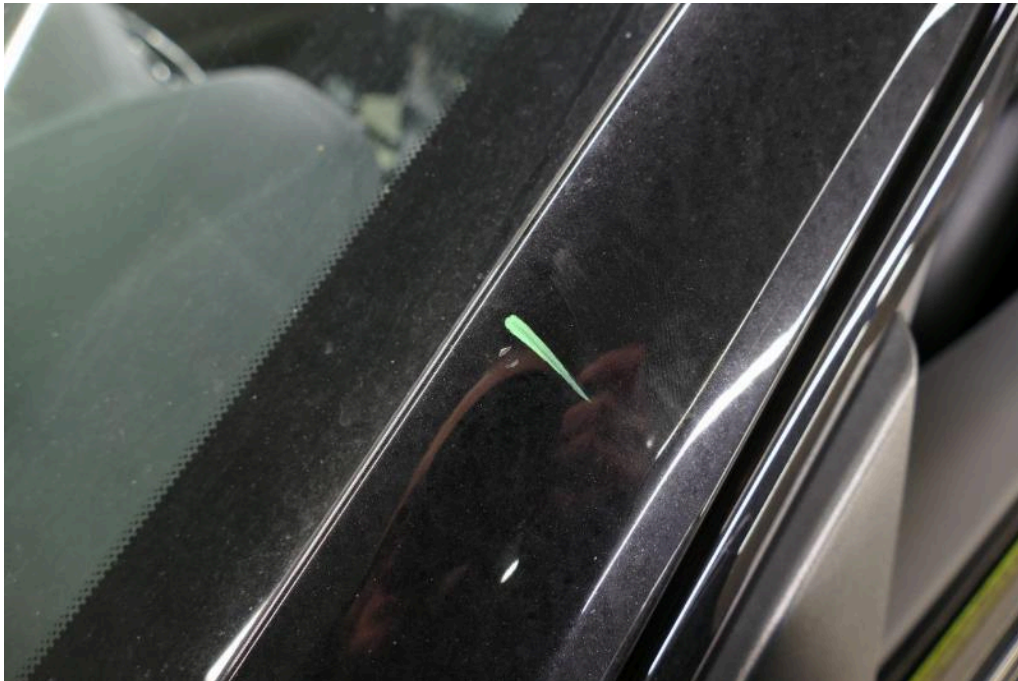
Bild 40 linke Seite A-Säule links Steinschlag/Vogelkotanhaftung Steinschlag
