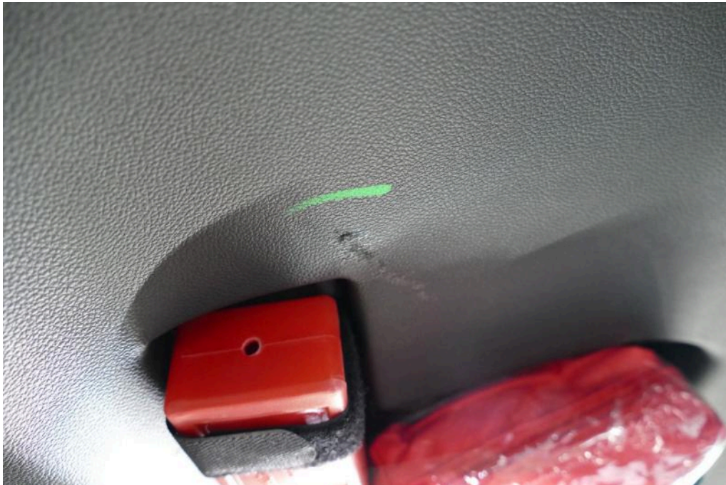
Bild 70 Innenraum Heckklappenverkleidung innen verkratzt
