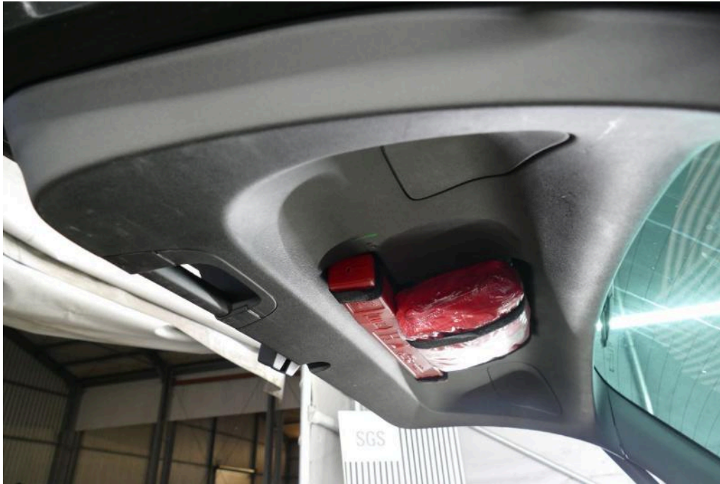
Bild 69 Innenraum Heckklappenverkleidung innen verkratzt
