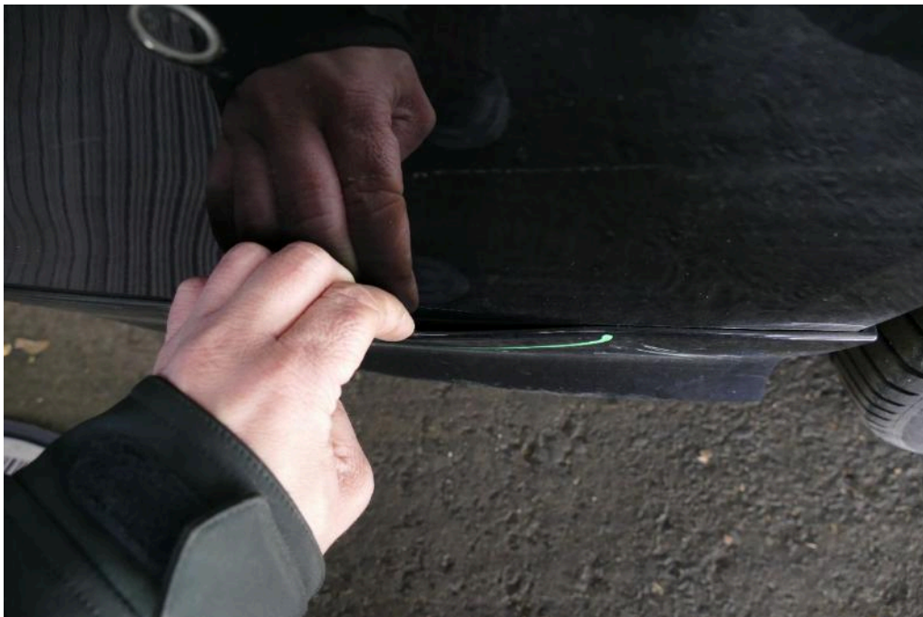
Bild 58 Fahrzeugheck Stoßfängerspoiler hinten Rechtsseitig gelöst
