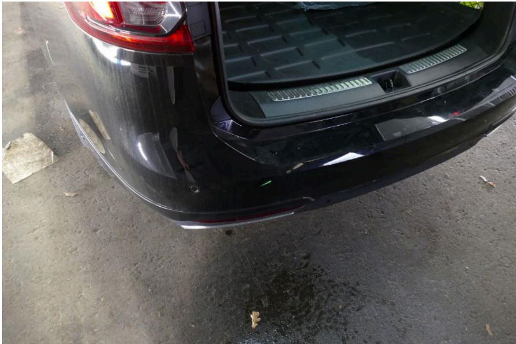
Bild 54 Fahrzeugheck Stoßfänger hinten Staubeinschlüsse/ punktuelle Lackschäden/Spaltmaßveränderung rechts
