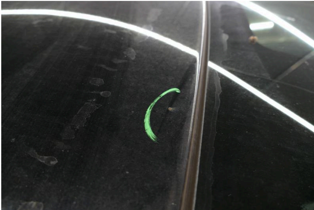
Bild 64 Dach Dachhaut Dellen/Vogelkotanhaftungen/Steinschlag
