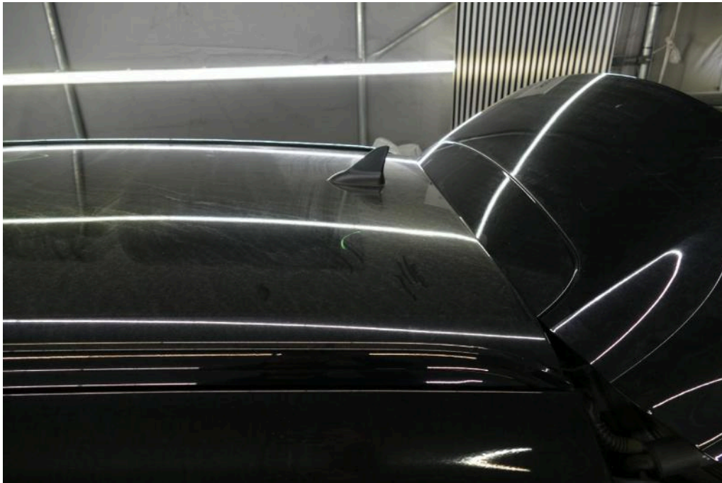
Bild 44 Dach Dachhaut Dellen/Vogelkotanhaftungen/Steinschlag
