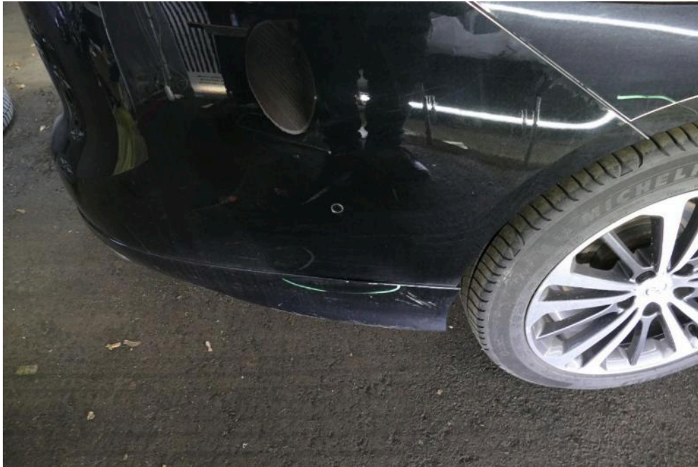
Bild 57 Fahrzeugheck Stoßfängerspoiler hinten Rechtsseitig gelöst
