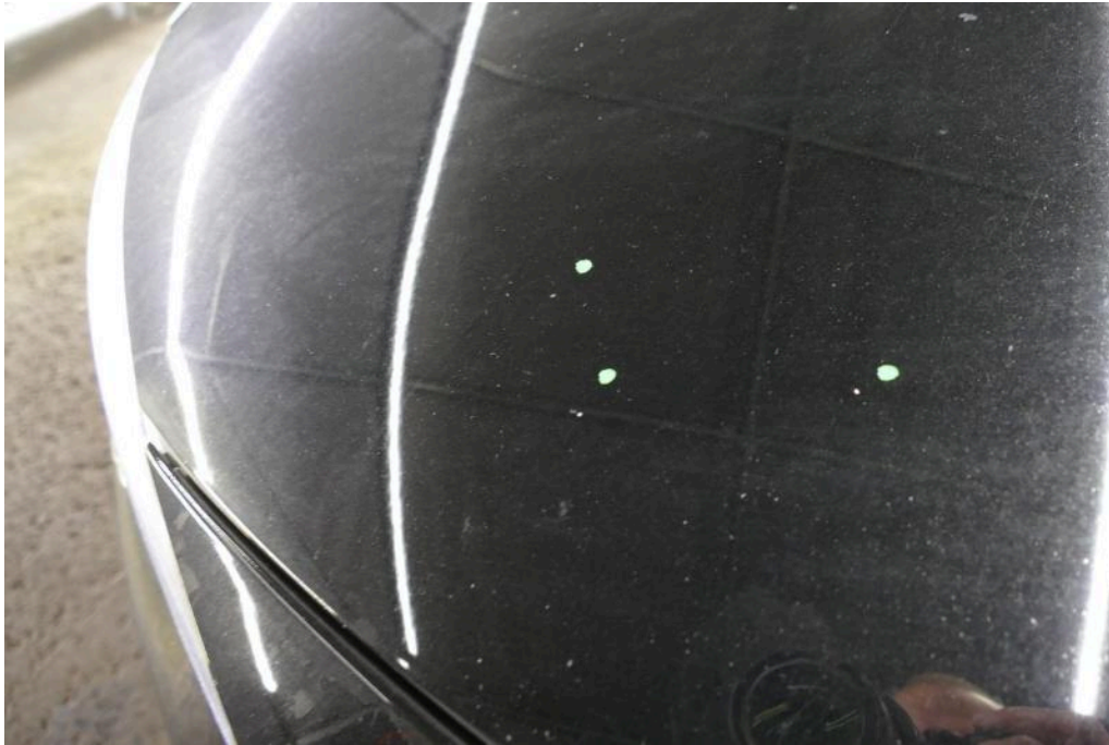
Bild 33 Fahrzeugfront Motorhaube Steinschläge/Vogelkotanhaftungen
