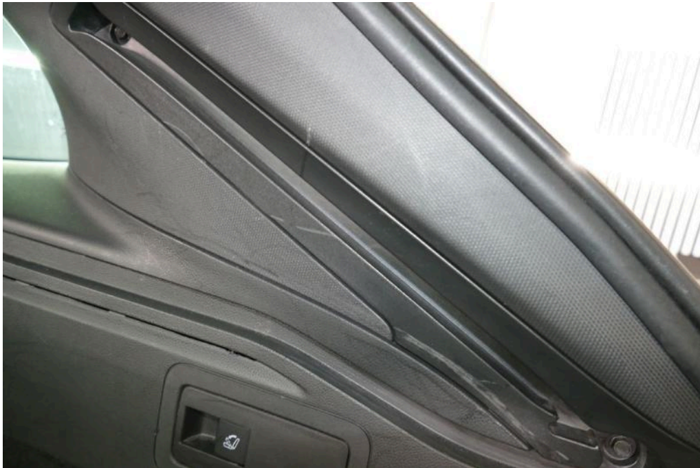
Bild 68 Innenraum Kofferraumverkleidung rechts verkratzt
