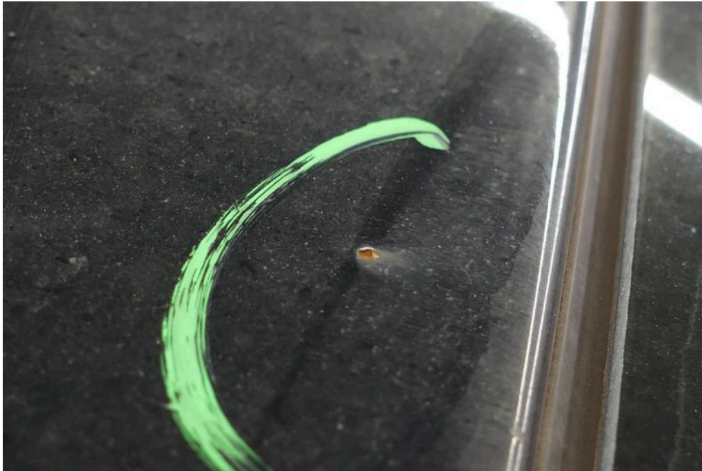
Bild 65 Dach Dachhaut Dellen/Vogelkotanhaftungen/Steinschlag
