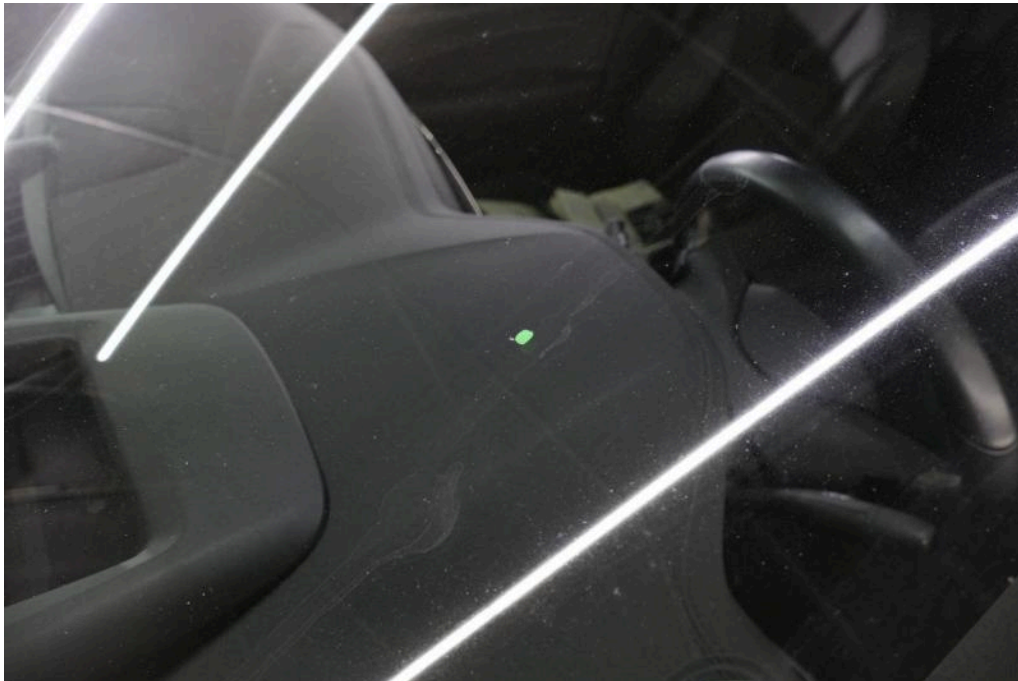
Bild 36 Fahrzeugfront Frontscheibe mit Regensensor Steinschlag / -schläge
