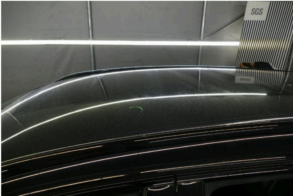
Bild 42 Dach Dachhaut Dellen/Vogelkotanhaftungen/Steinschlag
